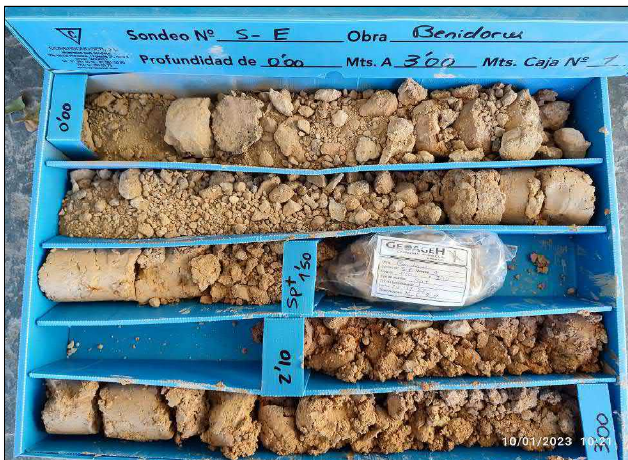
Figura 59: Sondeo E. Caja de sondeos 1 (0,00 – 3,00 m)
