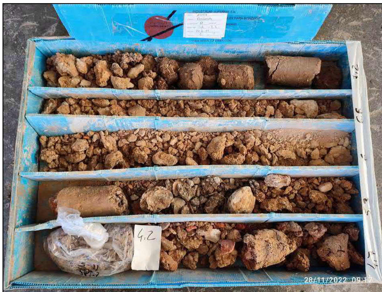
Figura 45: Sondeo n°11. Caja de sondeos 2 (3,60 – 7,20 m)
