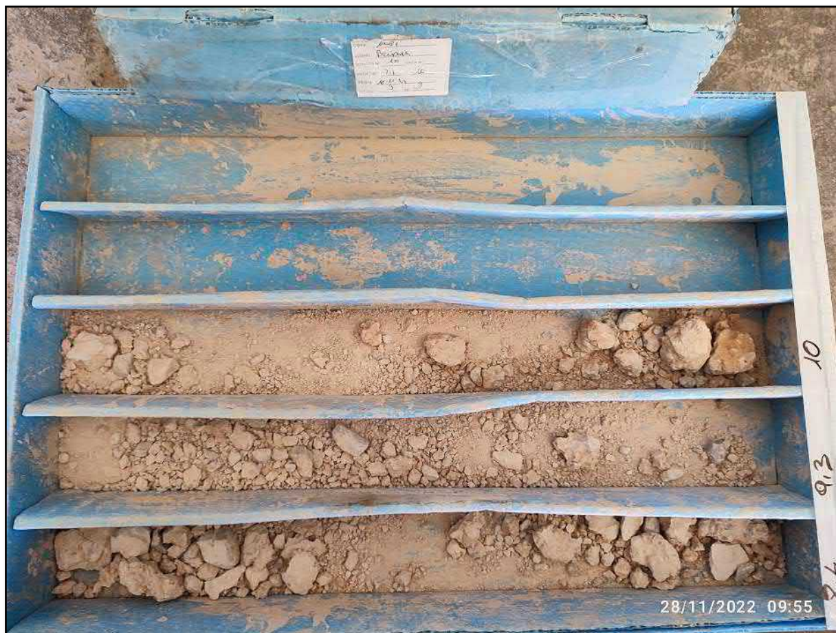
Figura 41: Sondeo n°10. Caja de sondeos 3 (7,70 – 10,00 m)
