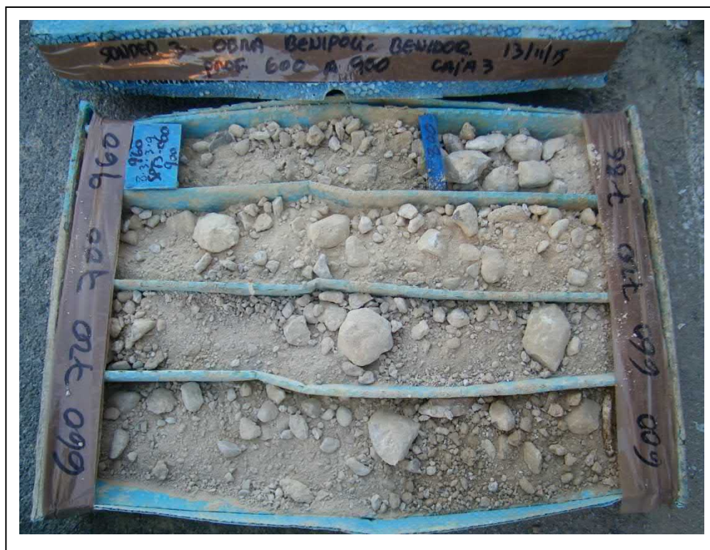
Foto 12. Caja de sondeo. Sondeo 3, de 6,00 a 9,60 m.
