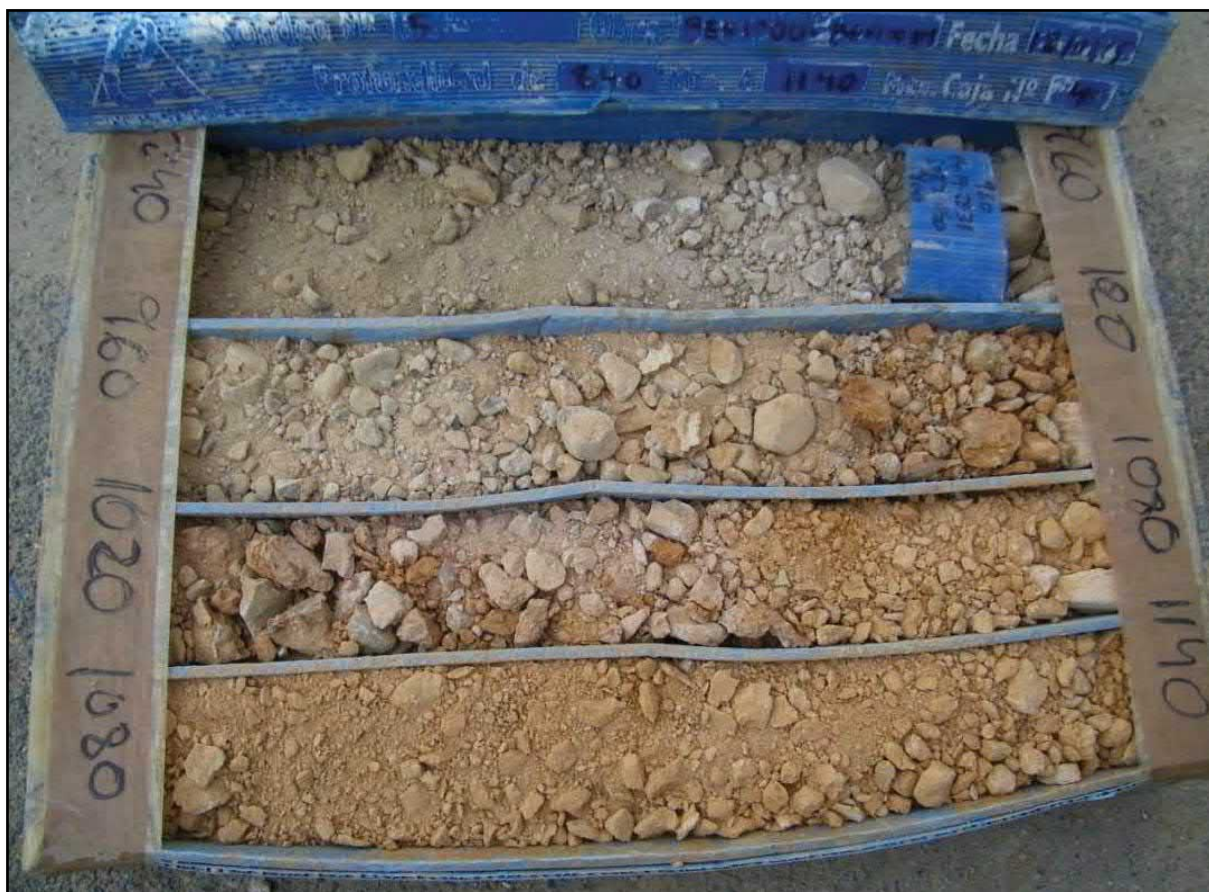
Figura 29: Sondeo a rotación 5*. Caja de sondeos 4 (8,40 – 11,40 m)
