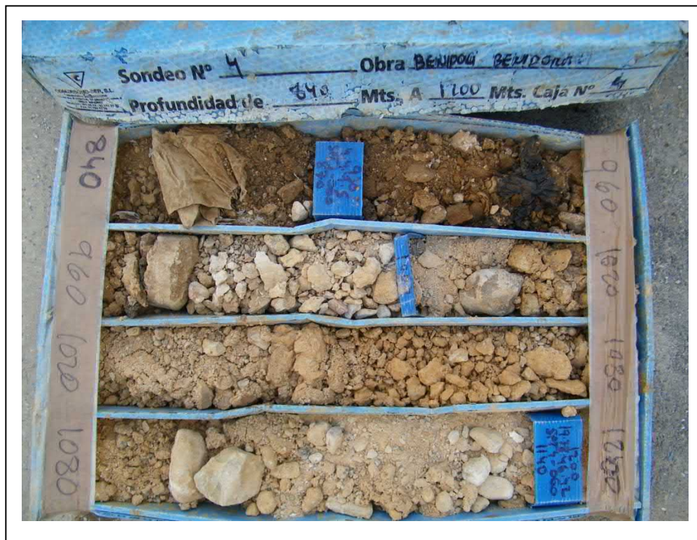
Foto 17. Caja de sondeo. Sondeo 4, de 8,40 a 12,00 m.
