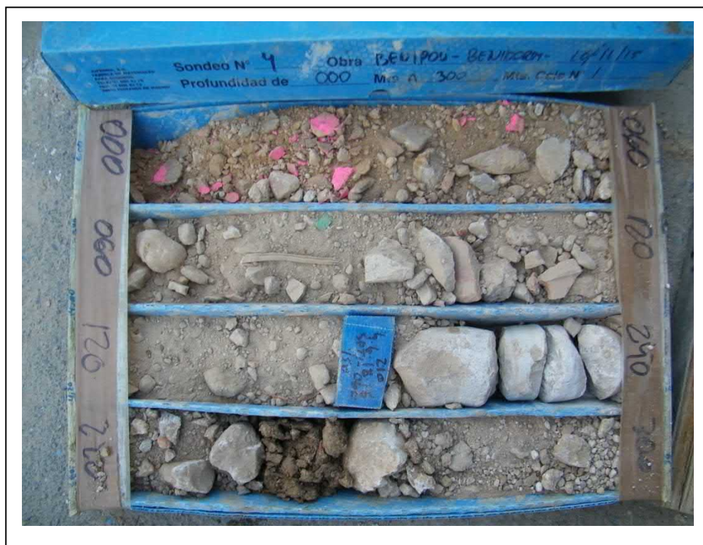
Foto 14. Caja de sondeo. Sondeo 4, de 0,00 a 3,00 m.
