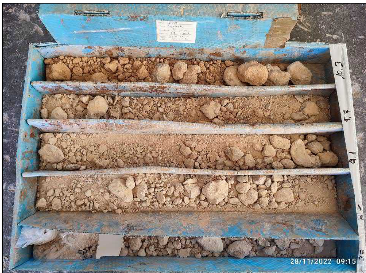
Figura 29: Sondeo n°7. Caja de sondeos 3 (7,20 – 10,30 m)
