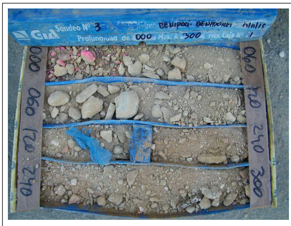
Foto 10. Caja de sondeo. Sondeo 3, de 0,00 a 3,00 m.
