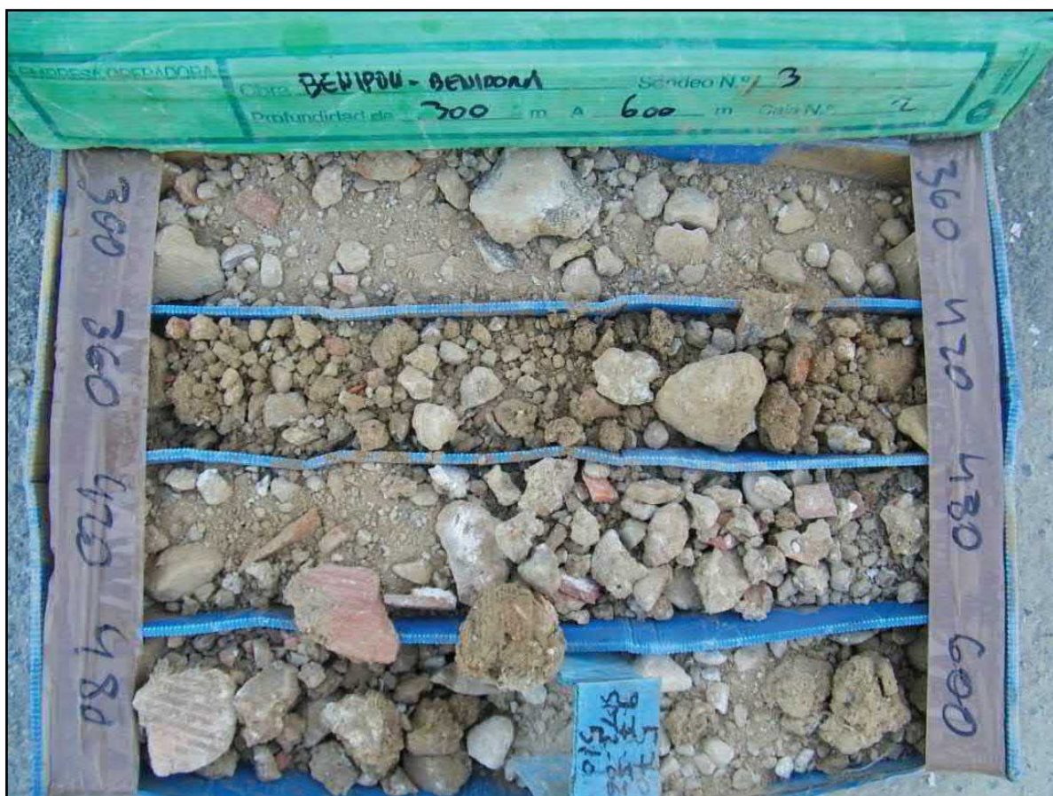
Figura 19: Sondeo a rotación 3*. Caja de sondeos 2 (3,00 – 6,00 m)
