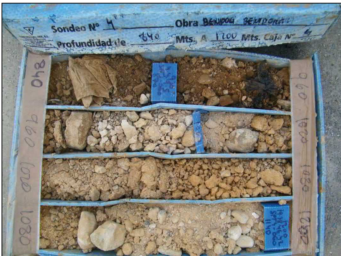
Figura 25: Sondeo a rotación 4*. Caja de sondeos 4 (8,40 – 12,00 m)
