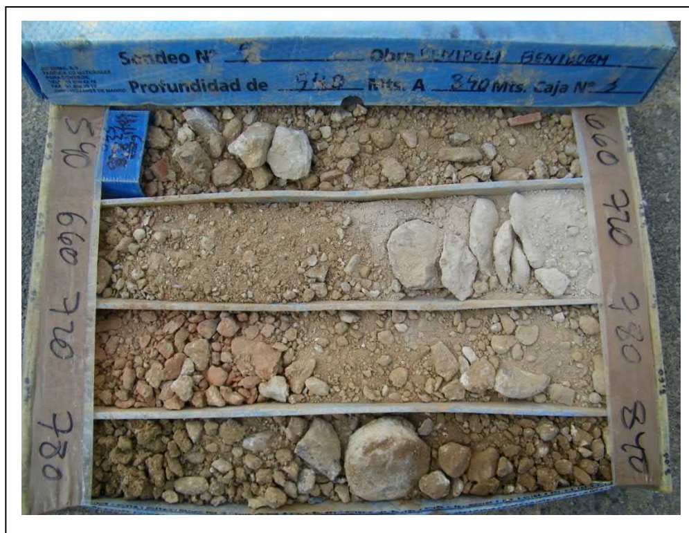
Foto 20. Caja de sondeo. Sondeo 5, de 5,40 a 8,40 m.
