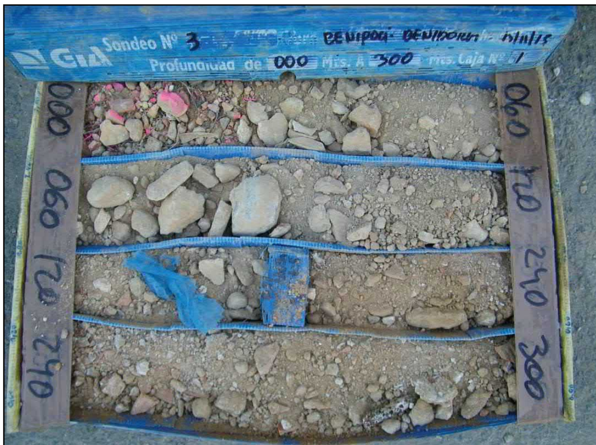
Figura 18: Sondeo a rotación 3*. Caja de sondeos 1 (0,00 – 3,00 m)
