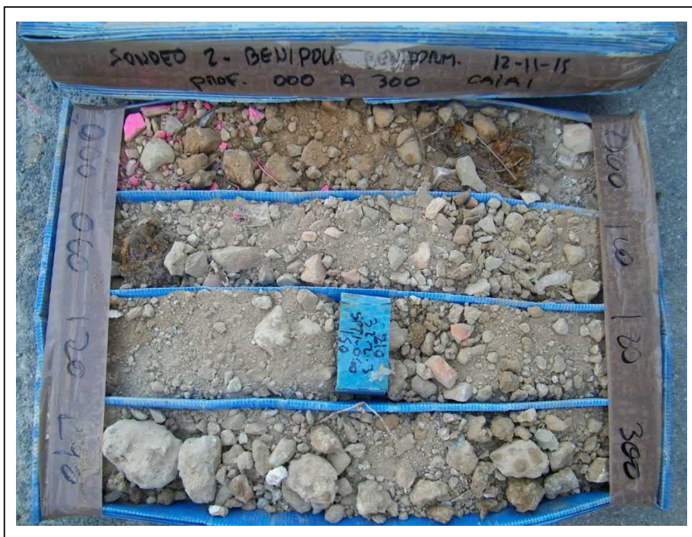
Foto 6. Caja de sondeo. Sondeo 2, de 0,00 a 3,00 m.
