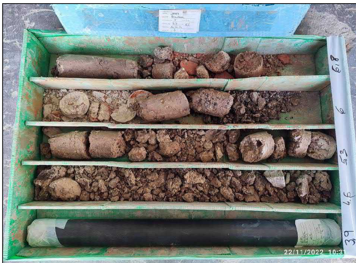
Figura 19: Sondeo n°5. Caja de sondeos 2 (3,30 – 6,80 m)
