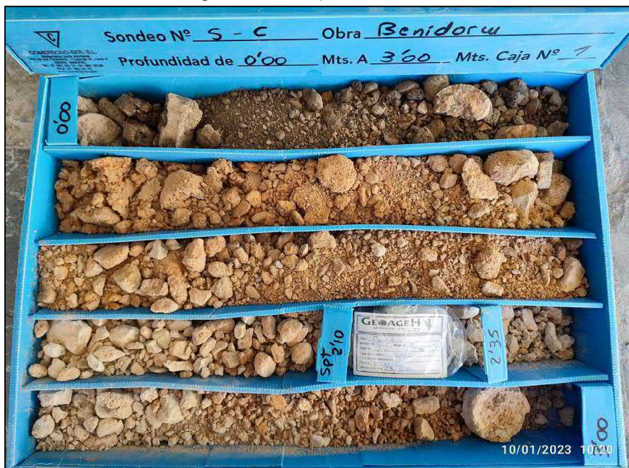
Figura 54: Sondeo C. Caja de sondeos 1 (0,00 – 3,00 m)
