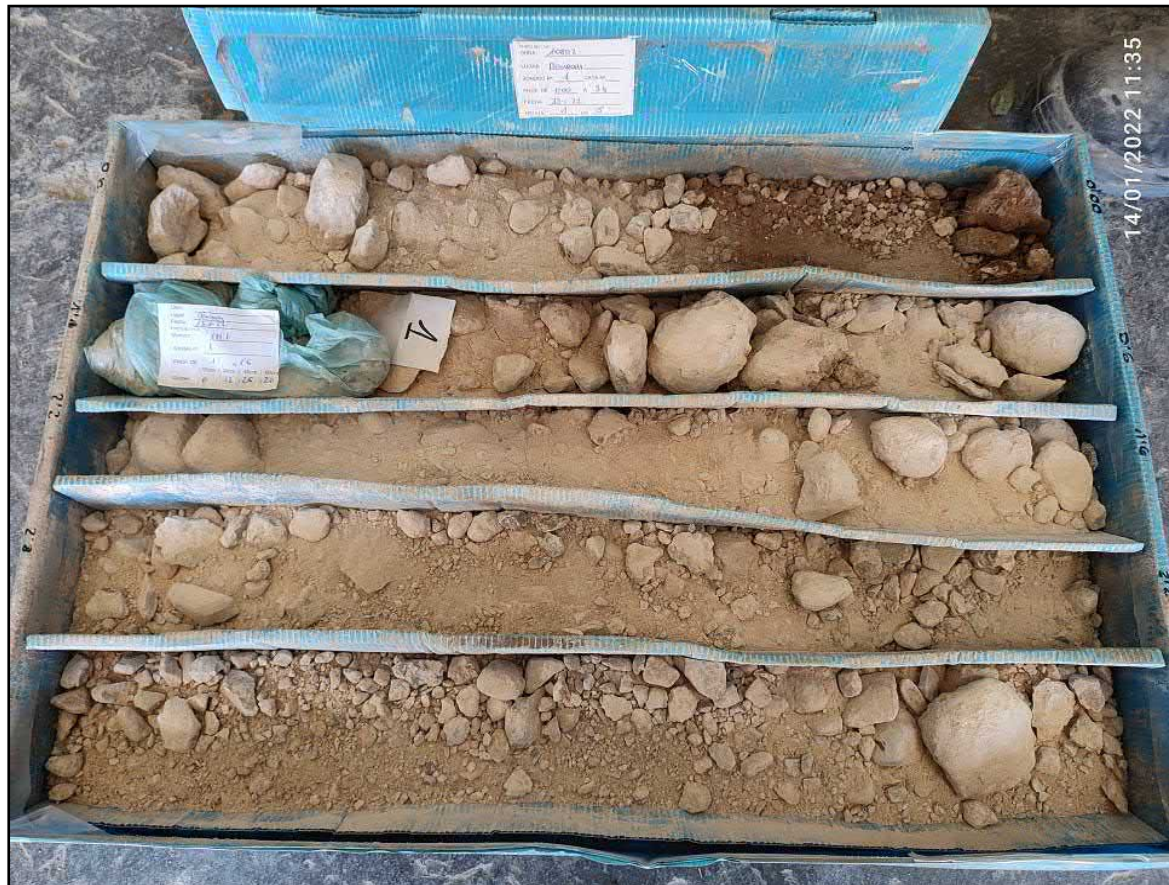
Figura 2: Sondeo a rotación 1. Caja de sondeos 1 (0,00 – 3,40 m)
