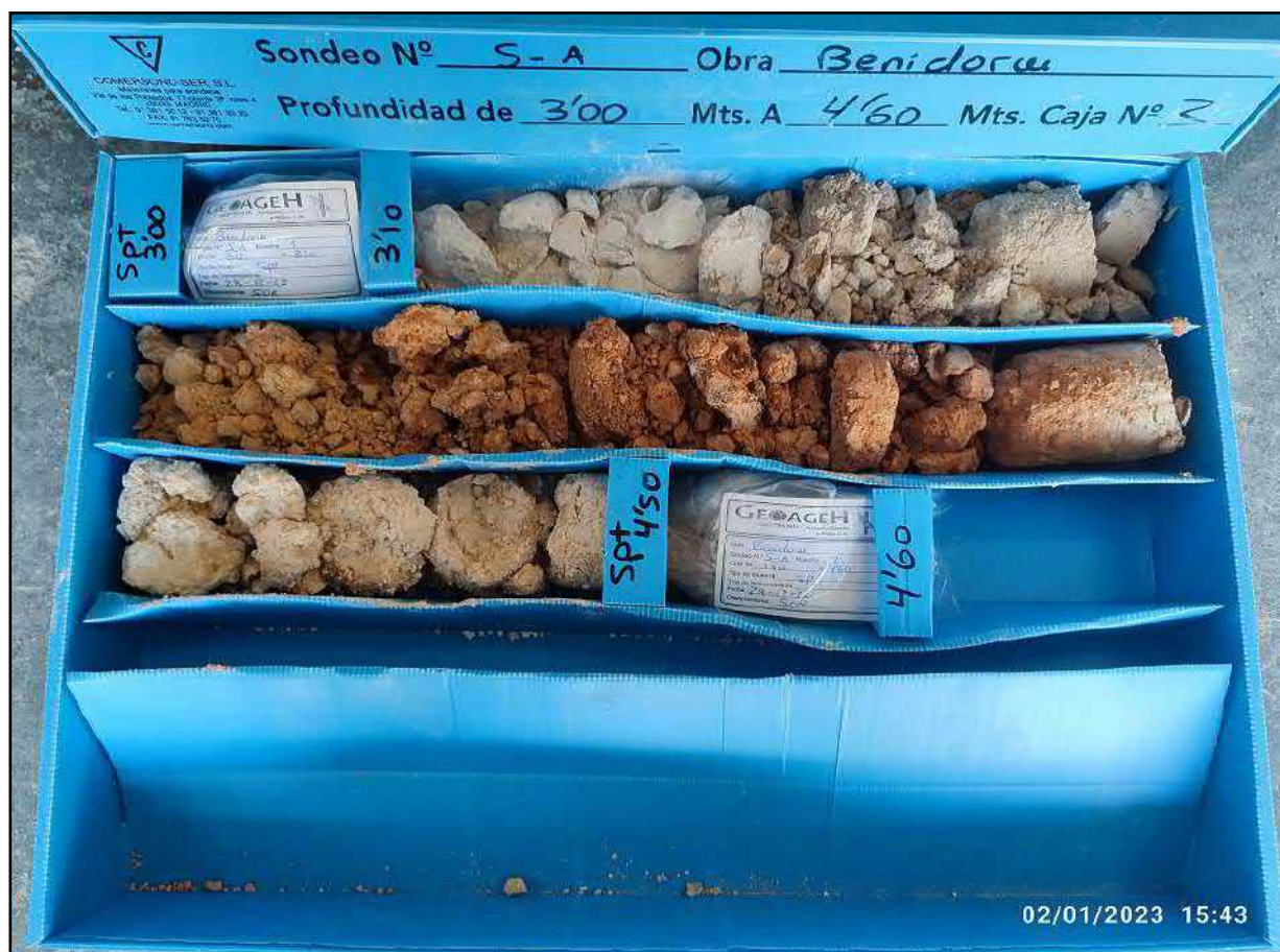
Figura 49: Sondeo A. Caja de sondeos 2 (3,00 – 4,60 m)
