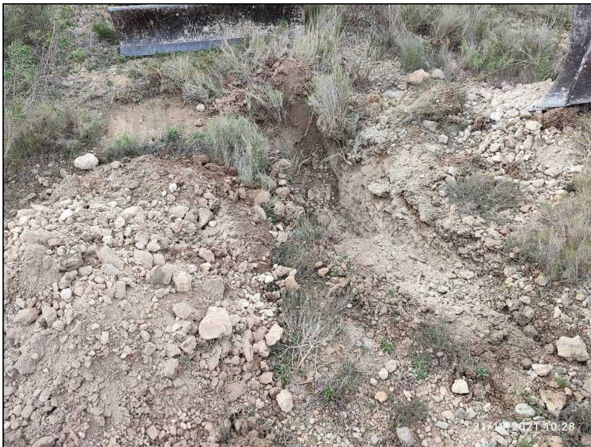
Figura 7: Cata 1 realizada en el terreno. Profundidad 0,30 m.
