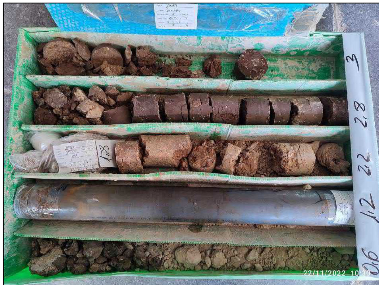
Figura 2: Sondeo nº1. Caja de sondeos 1 (0,00 – 3,00 m)
