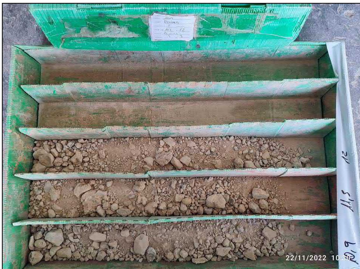
Figura 21: Sondeo nº5. Caja de sondeos 4 (10,20 – 12,00 m)
