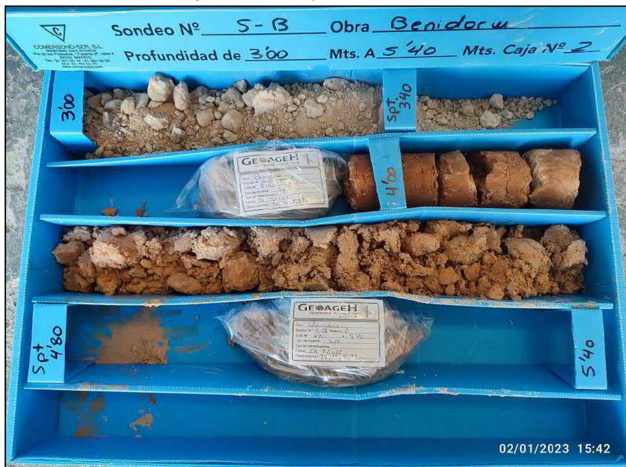
Figura 52: Sondeo B. Caja de sondeos 2 (3,00 – 5,40 m)
