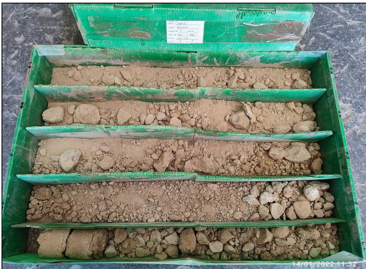
Figura 4: Sondeo a rotación 1. Caja de sondeos 3 (6,60 – 9,80 m)
