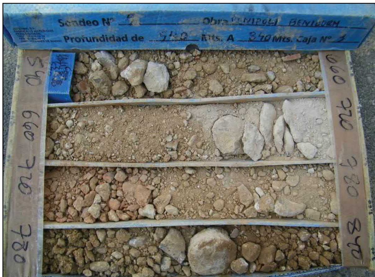
Figura 28: Sondeo a rotación 5*. Caja de sondeos 3 (5,40 – 8,40 m)
