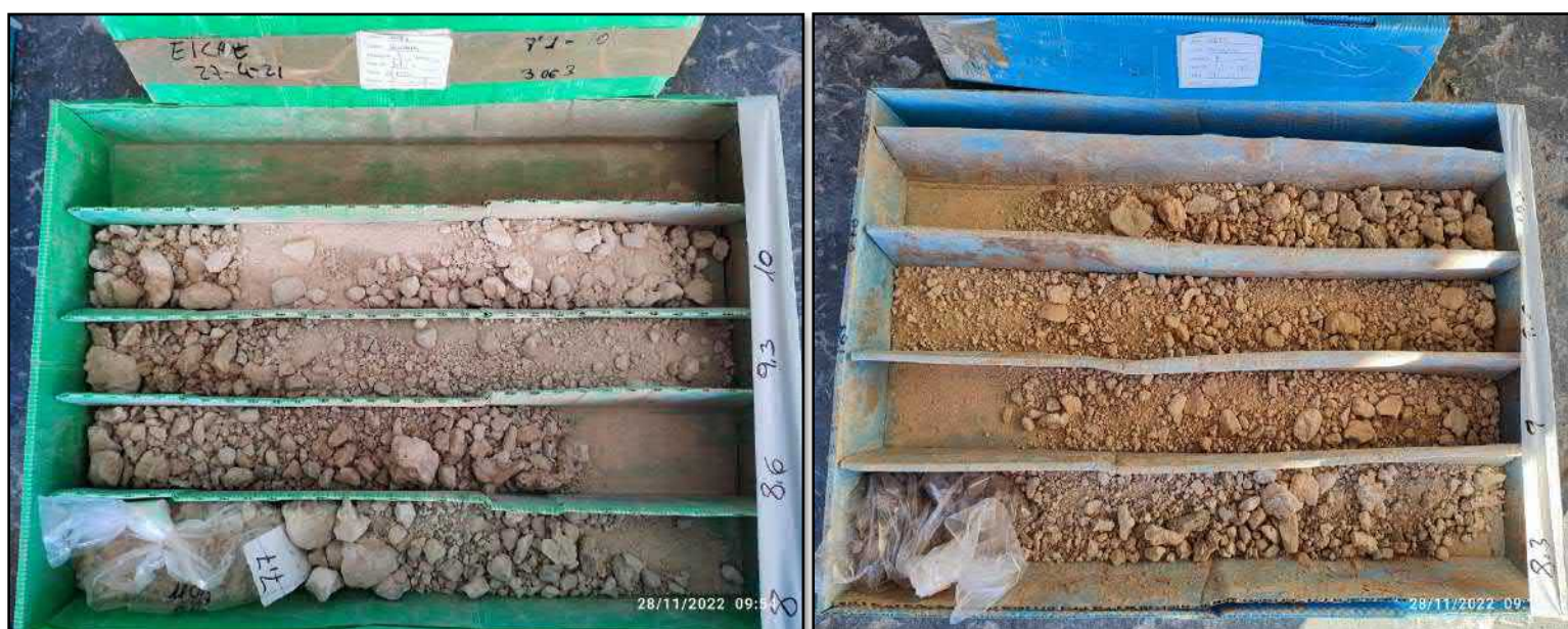
Figura 7: Estratigrafía del nivel II litológico en los sondeos realizados (8,00 – 10,00 m).
