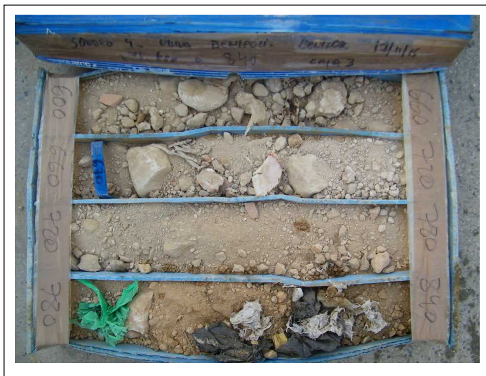
Foto 16. Caja de sondeo. Sondeo 4, de 6,00 a 8,40 m.
