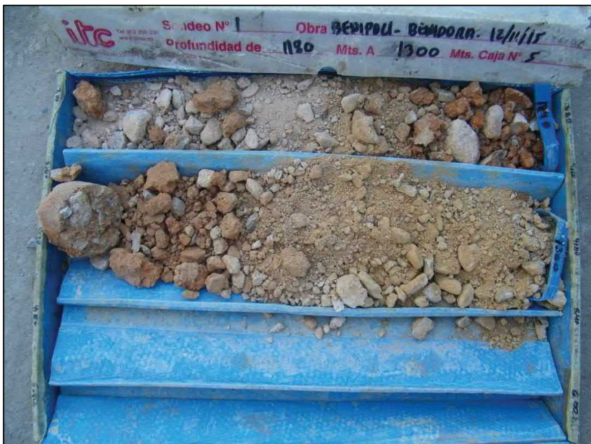
Figura 13: Sondeo a rotación 1*. Caja de sondeos 5 (18,80 – 13,00 m)
