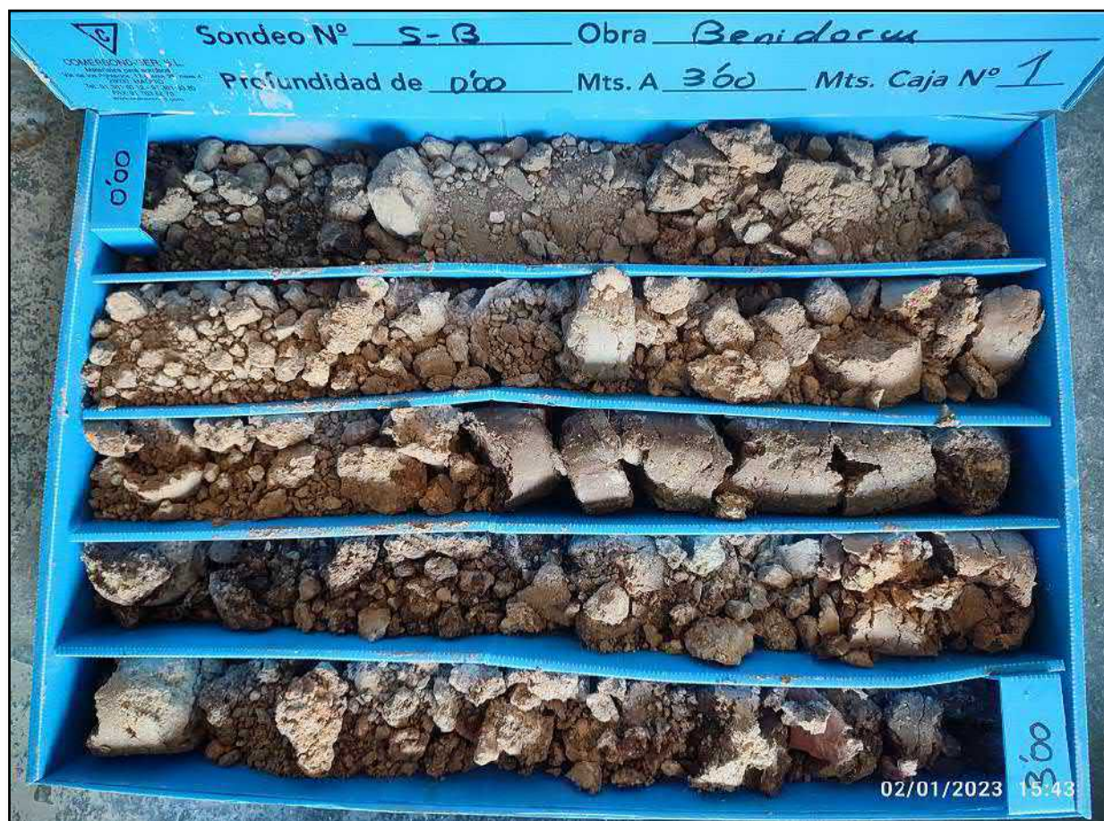
Figura 51: Sondeo B. Caja de sondeos 1 (0,00 – 3,00 m)
