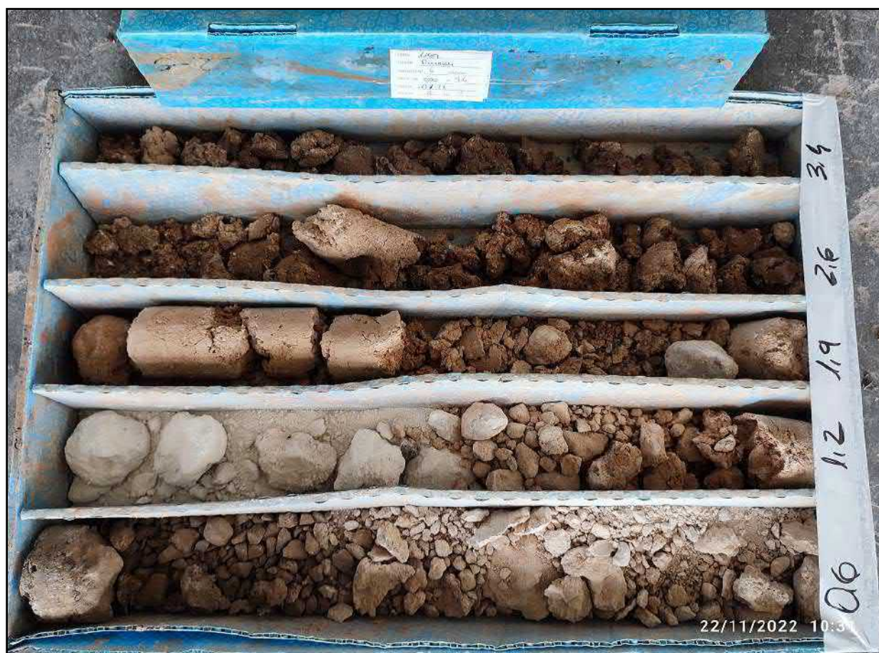
Figura 23: Sondeo nº6. Caja de sondeos 1 (0,00 – 3,40 m)
