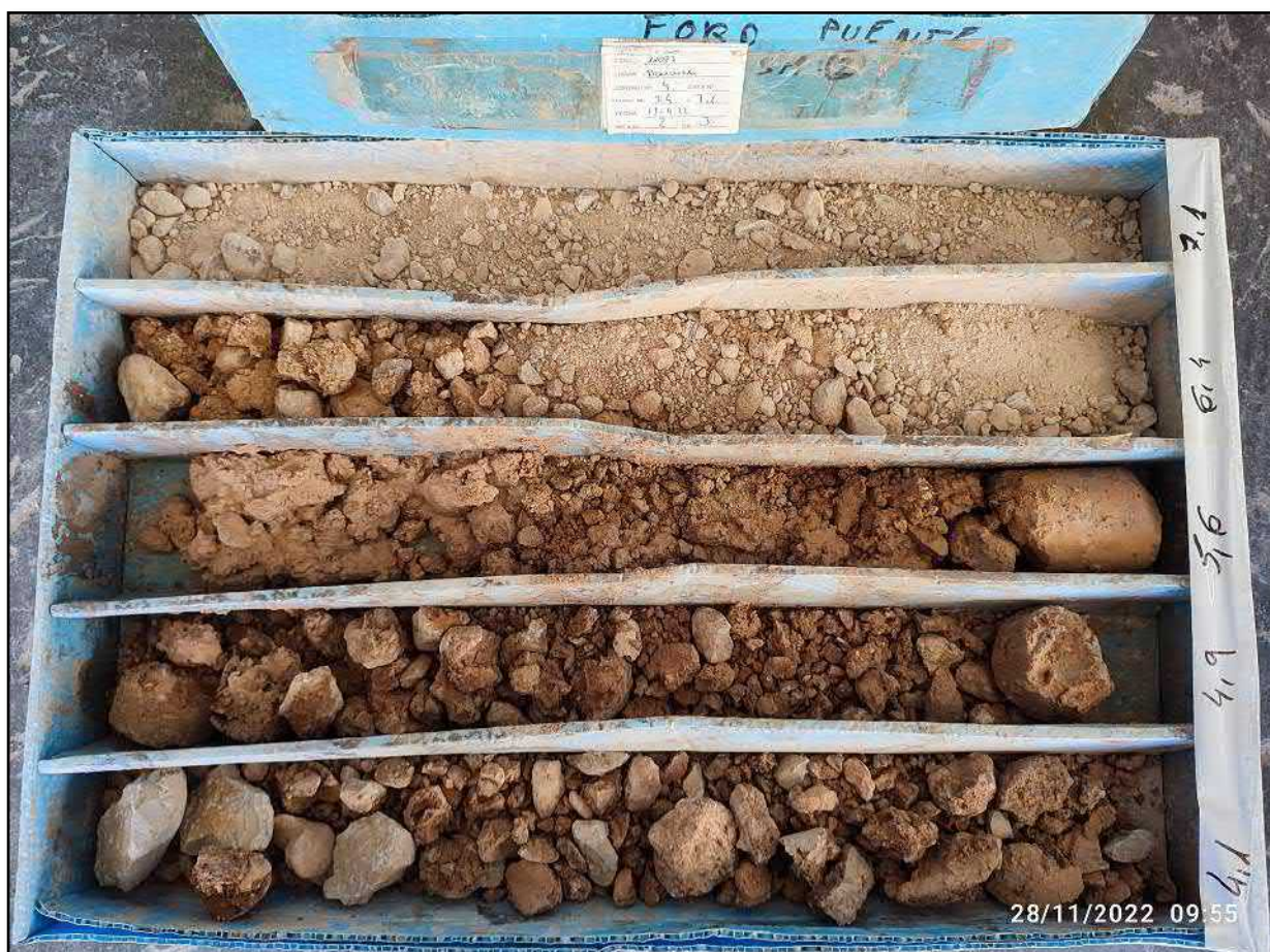
Figura 15: Sondeo nº4. Caja de sondeos 2 (3,40 – 7,60 m)
