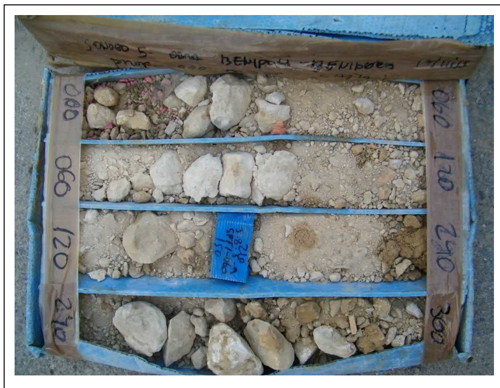
Foto 18. Caja de sondeo. Sondeo 5, de 0,00 a 3,00 m.
