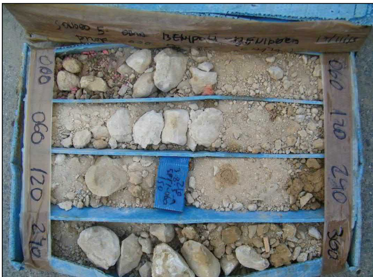
Figura 26: Sondeo a rotación 5*. Caja de sondeos 1 (0,00 – 3,00 m)
