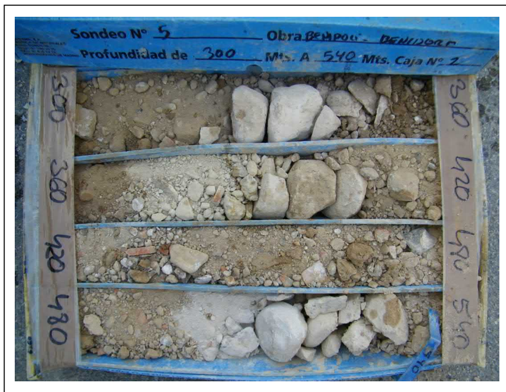
Foto 19. Caja de sondeo. Sondeo 2, de 3,00 a 5,40 m.
