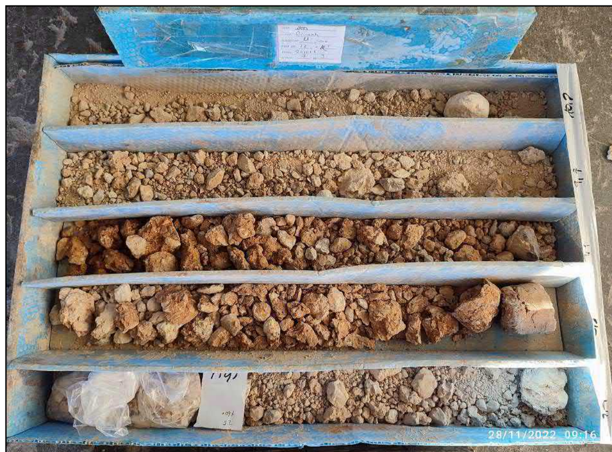
Figura 46: Sondeo n°11. Caja de sondeos 3 (7,20 – 10,20 m)
