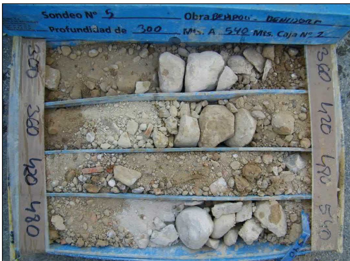
Figura 27: Sondeo a rotación 5*. Caja de sondeos 2 (3,00 – 5,40 m)
