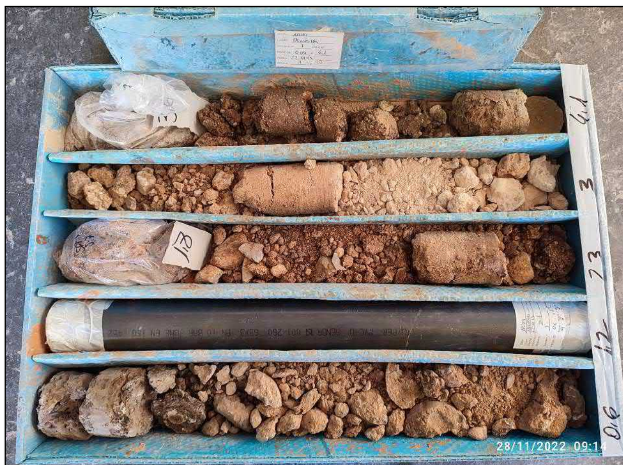
Figura 27: Sondeo n.º 7. Caja de sondeos 1 (0,00 – 4,10 m)
