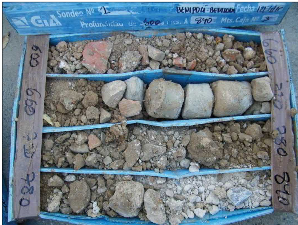
Figura 16: Sondeo a rotación 2*. Caja de sondeos 3 (6,00 – 8,40 m)
