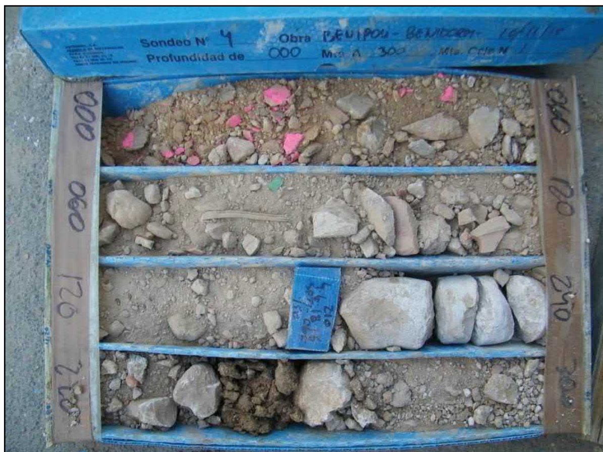
Figura 22: Sondeo a rotación 4*. Caja de sondeos 1 (0,00 – 3,00 m)
