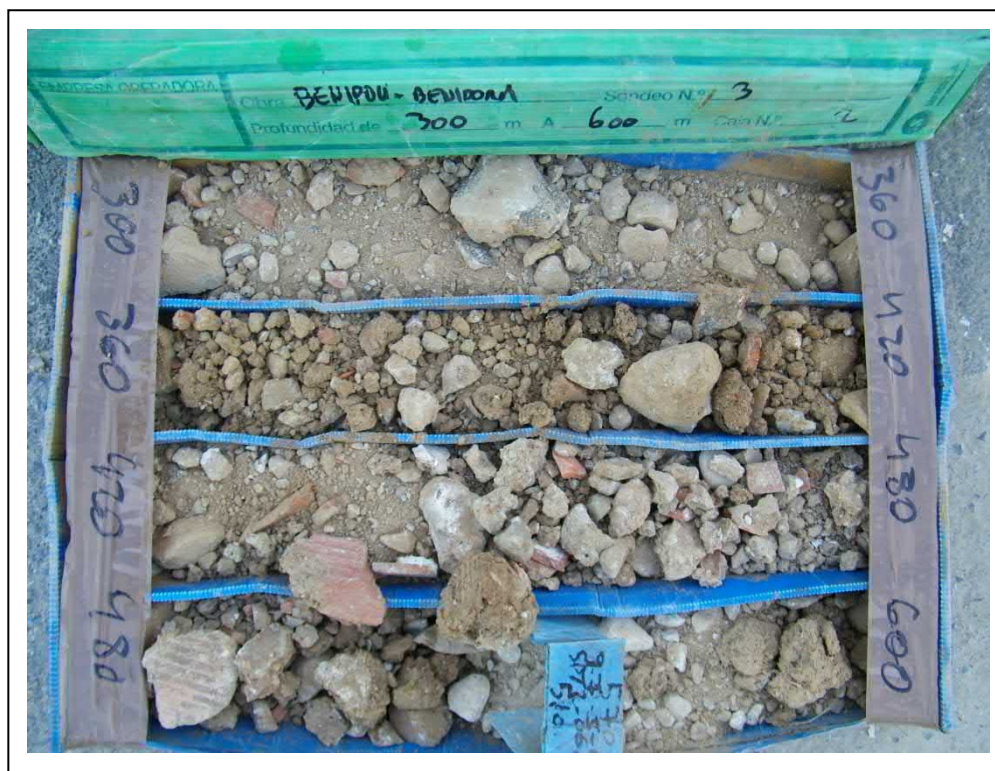
Foto 11. Caja de sondeo. Sondeo 3, de 0,00 a 6,00 m.
