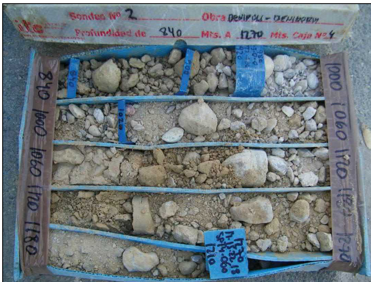
Figura 17: Sondeo a rotación 2*. Caja de sondeos 4 (8,40 – 12,70 m)
