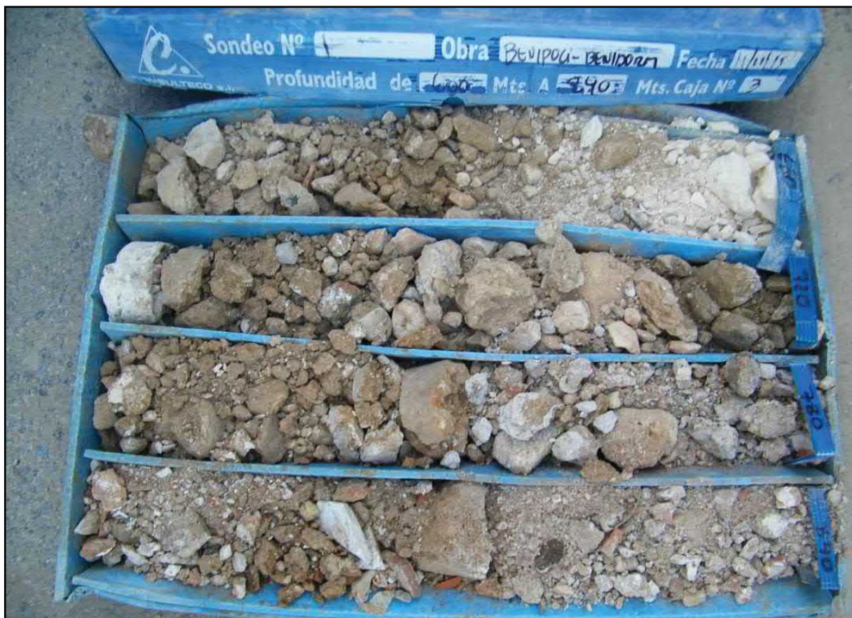
Figura 11: Sondeo a rotación 1*. Caja de sondeos 3 (6,00 – 8,40 m)
