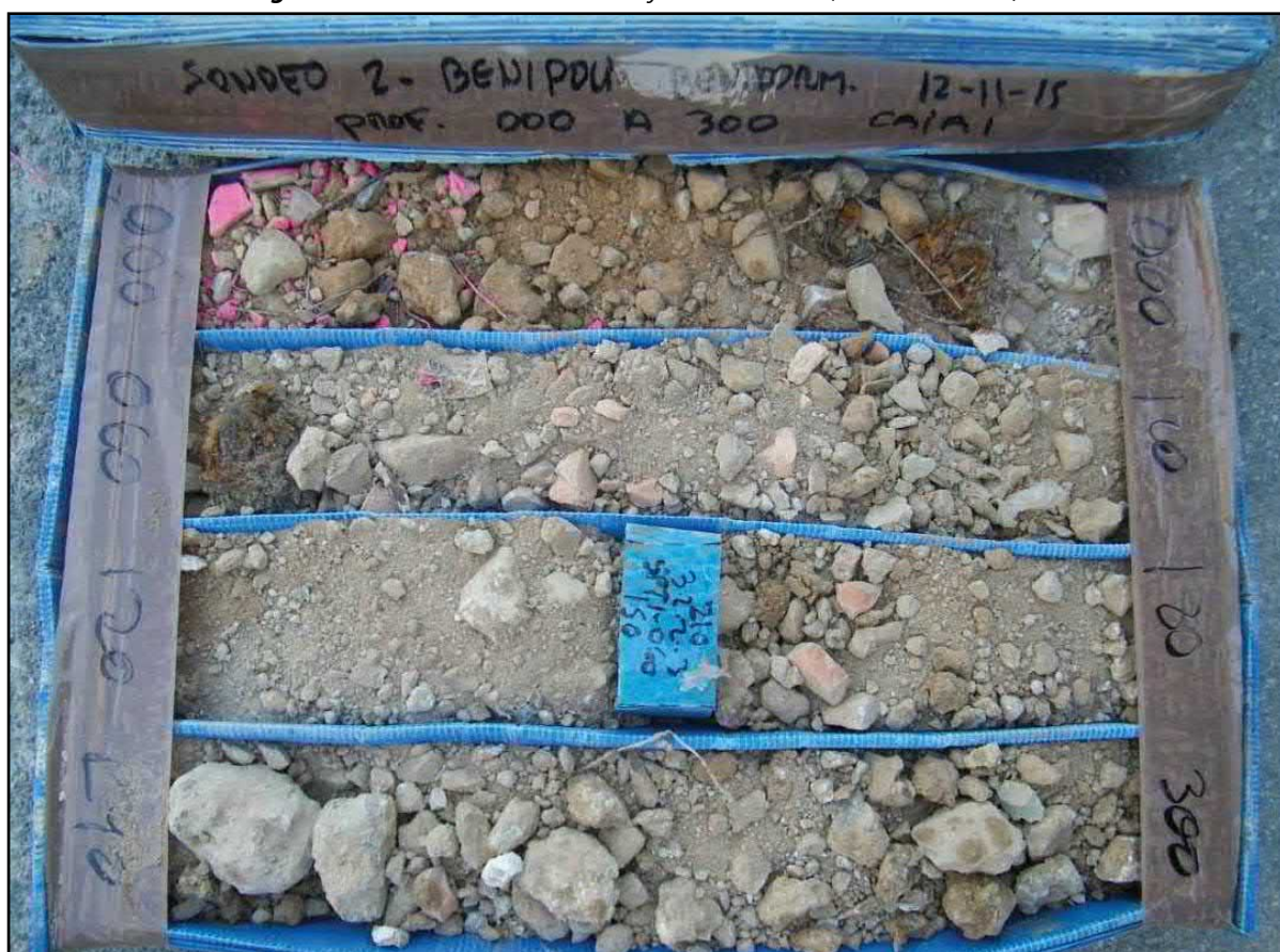
Figura 14: Sondeo a rotación 2*. Caja de sondeos 1 (0,00 – 3,00 m)
