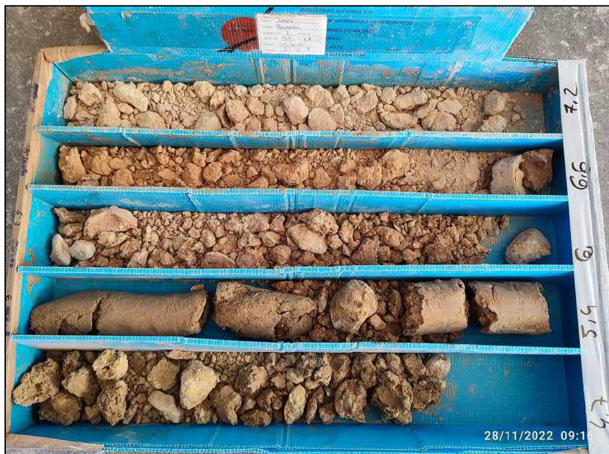
Figura 28: Sondeo n.º 7. Caja de sondeos 2 (4,10 – 7,20 m)
