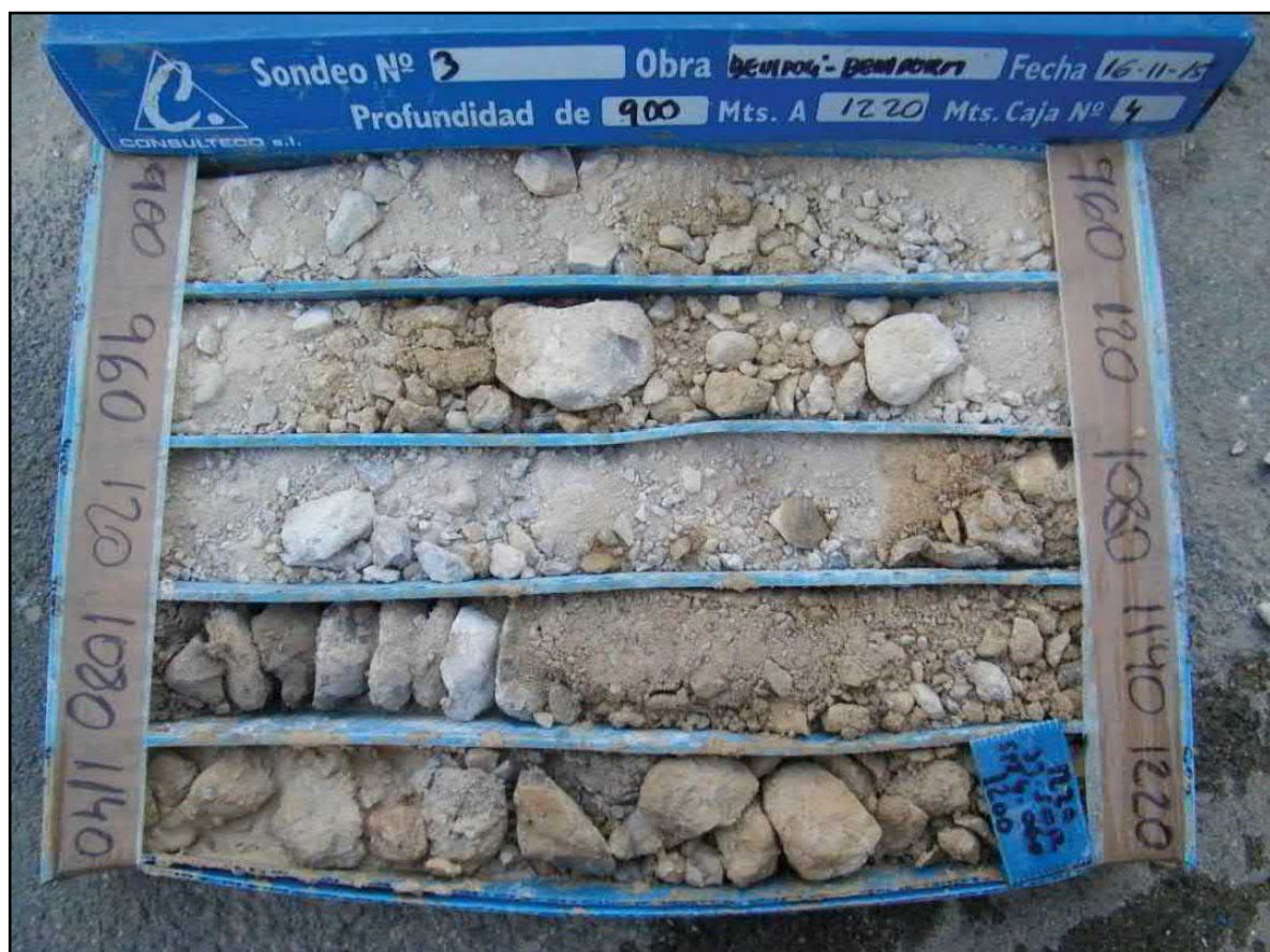
Figura 21: Sondeo a rotación 3*. Caja de sondeos 3 (9,00 – 12,20 m)
