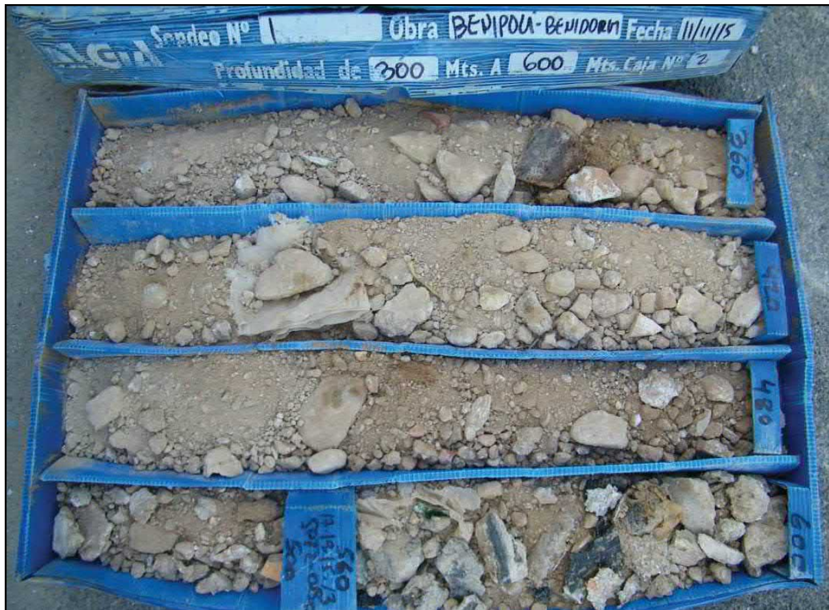
Figura 12: Sondeo a rotación 1*. Caja de sondeos 2 (3,00 – 6,00 m)
