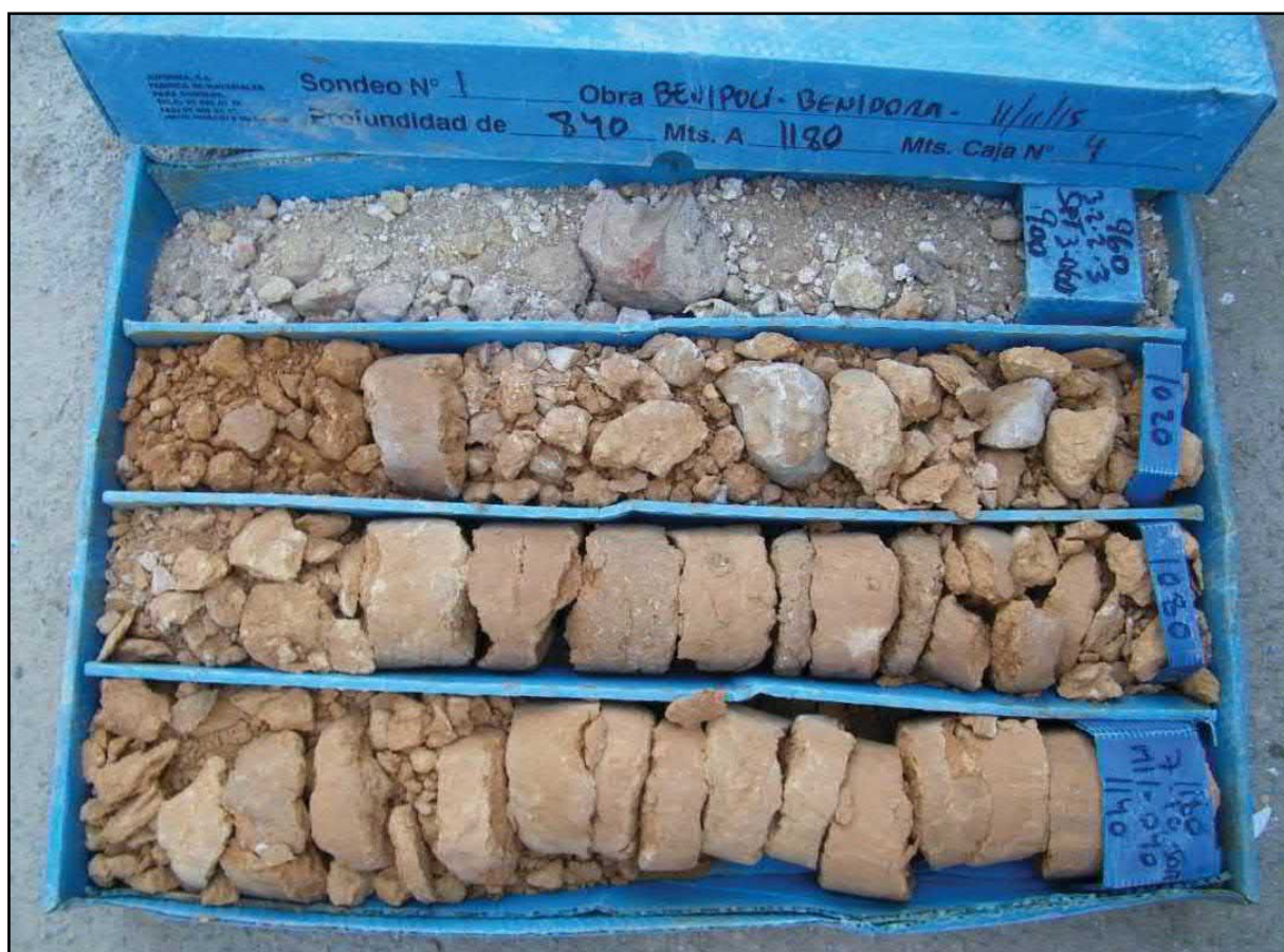
Figura 12: Sondeo a rotación 1*. Caja de sondeos 4 (8,40 – 11,80 m)
