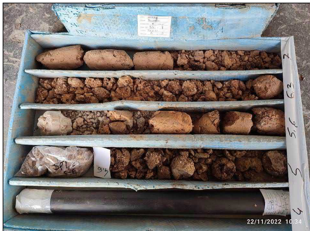
Figura 24: Sondeo nº6. Caja de sondeos 2 (3,40 – 7,00 m)
