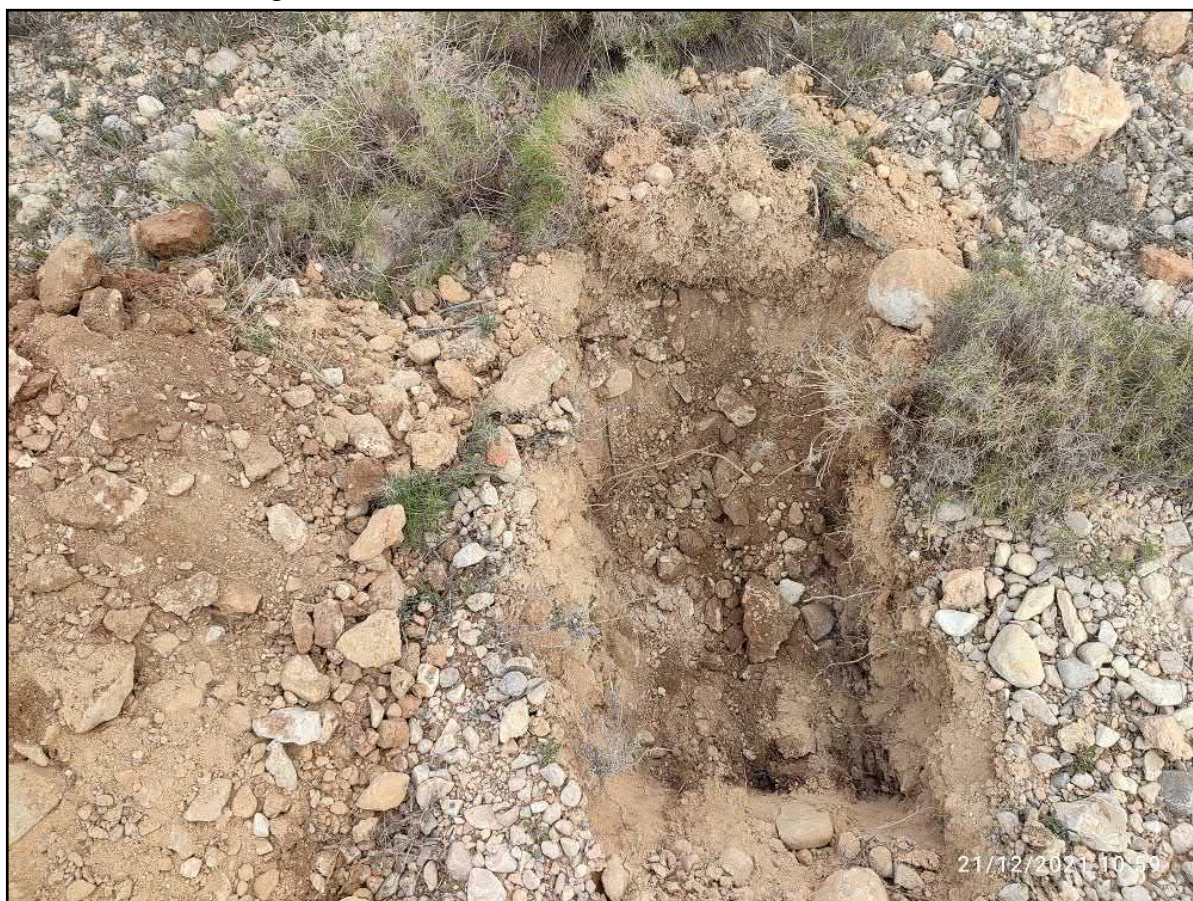
Figura 10: Cata 4 realizada en el terreno. Profundidad 0,40 m.
