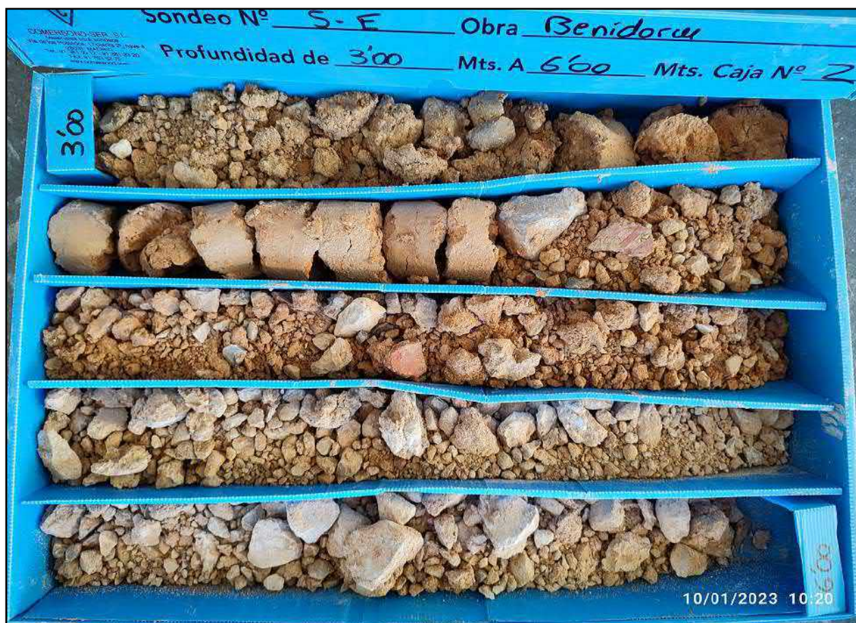
Figura 60: Sondeo E. Caja de sondeos 2 (3,00 – 6,00 m)
