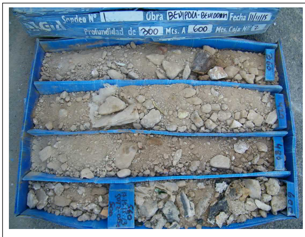
Foto 2. Caja de sondeo. Sondeo 1, de 3,00 a 6,00 m.
