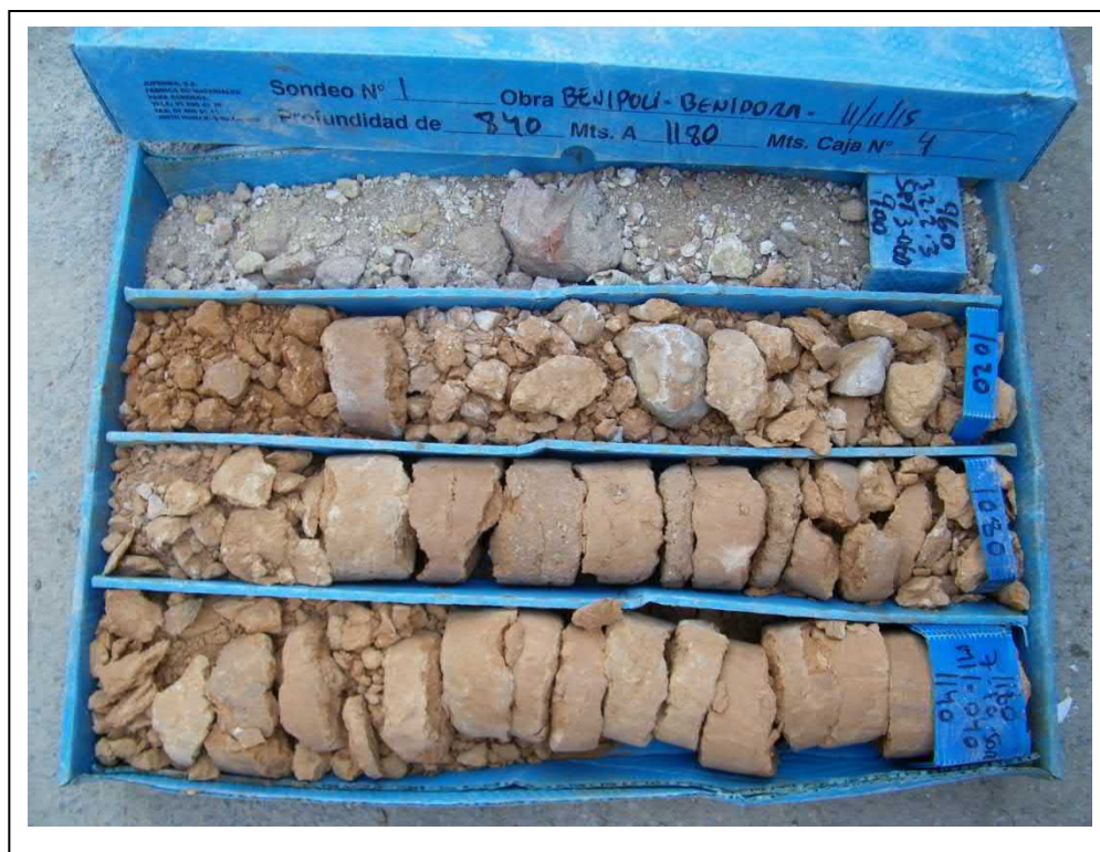
Foto 4. Caja de sondeo. Sondeo 1, de 9,00 a 11,80 m.
