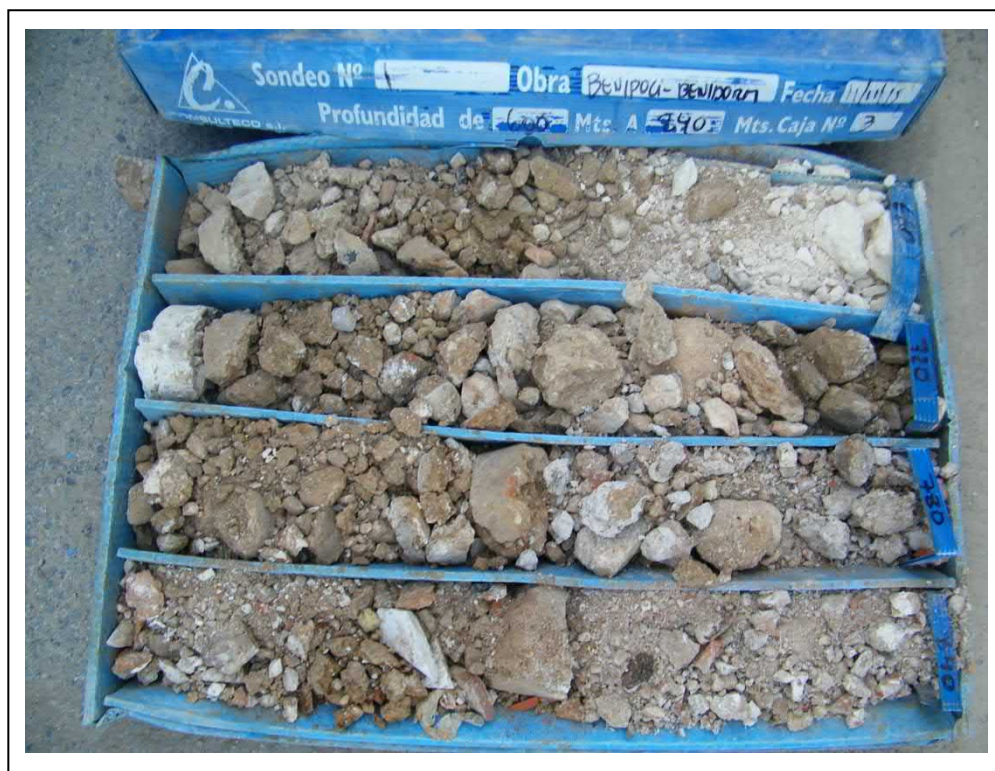
Foto 3. Caja de sondeo. Sondeo 1, de 6,00 a 9,00 m.
