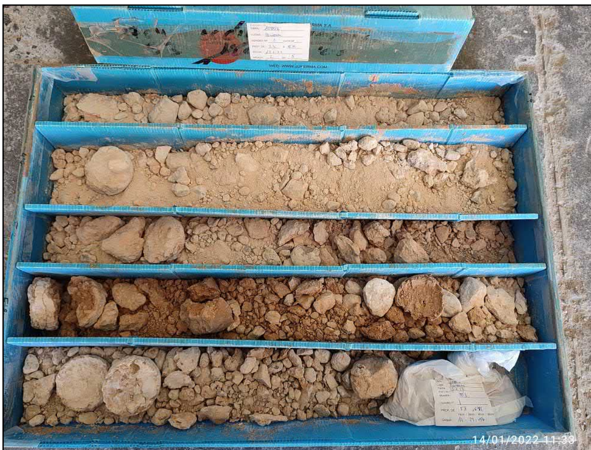
Figura 3: Sondeo a rotación 1. Caja de sondeos 2 (3,40 – 6,60 m)
