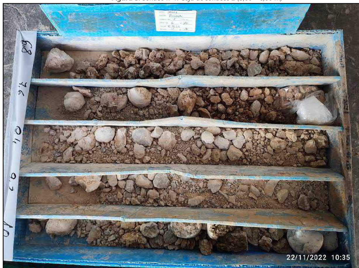
Figura 4: Sondeo n°1. Caja de sondeos 3 (6,00 – 10,00 m)
