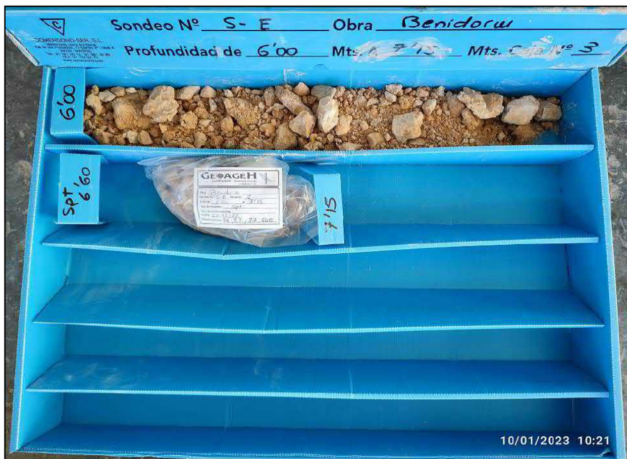
Figura 61: Sondeo E. Caja de sondeos 3 (6,00 – 7,15 m)
