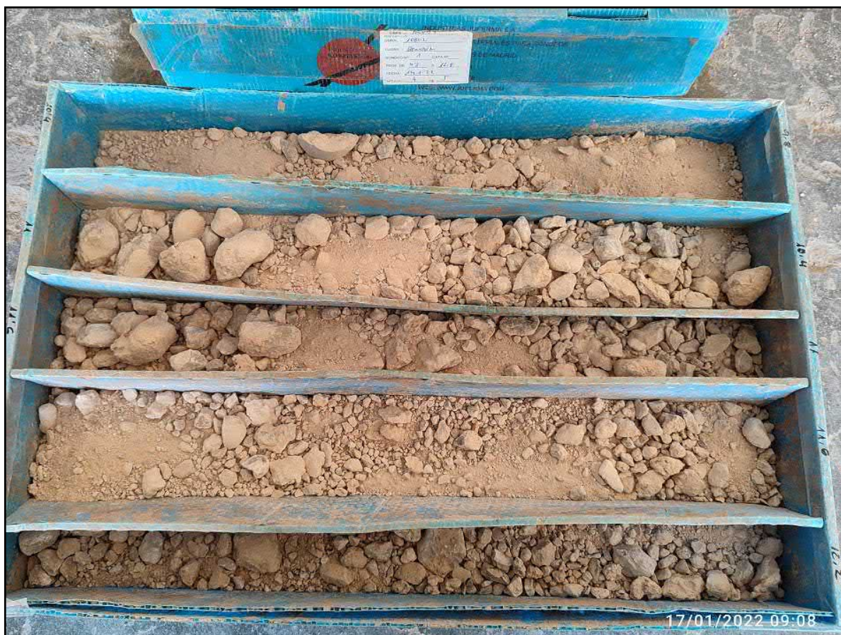
Figura 5: Sondeo a rotación 1. Caja de sondeos 4 (9,80 – 12,80 m)
