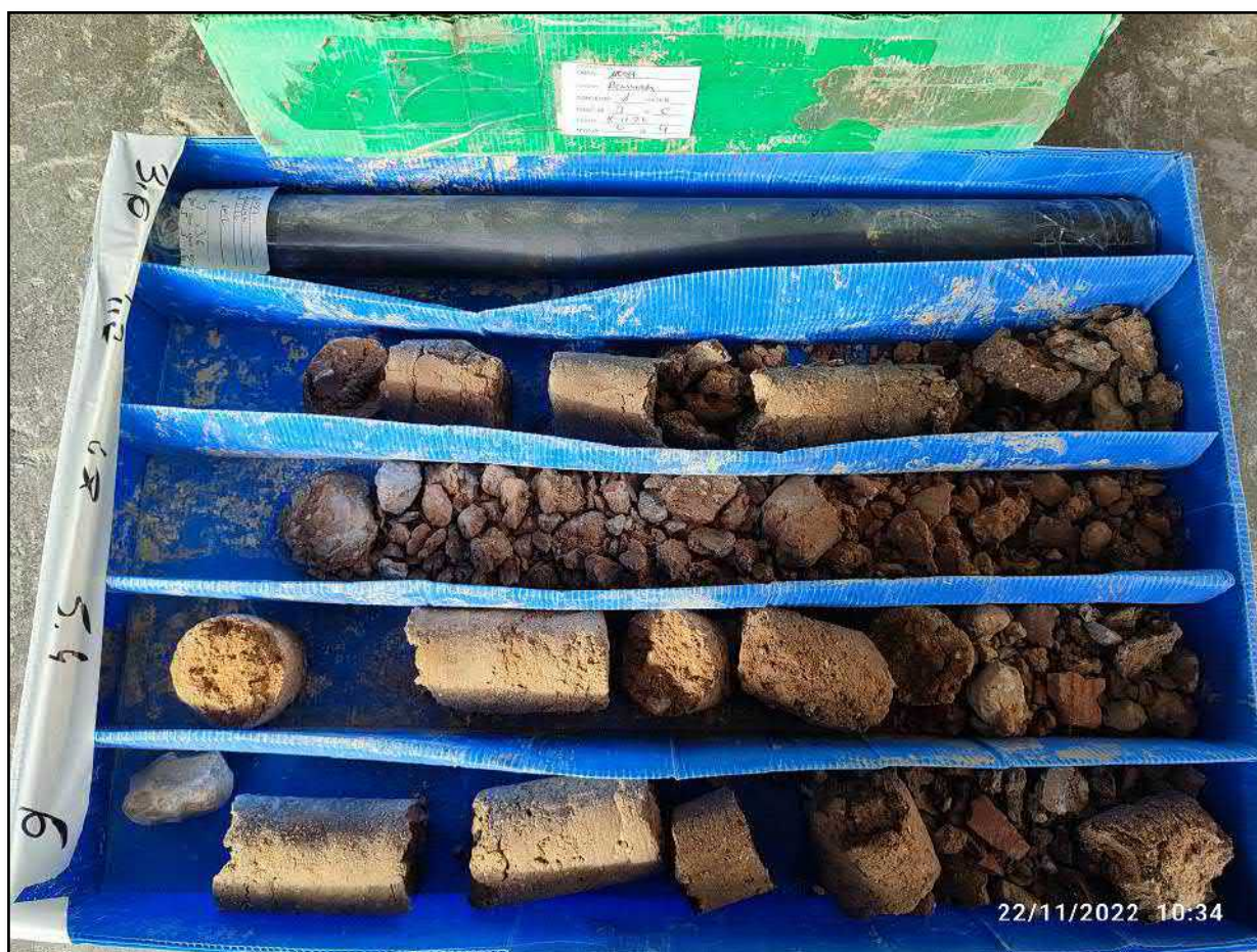
Figura 3: Sondeo n°1. Caja de sondeos 2 (3,00 – 6,00 m)
