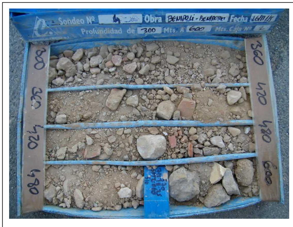
Foto 15. Caja de sondeo. Sondeo 4, de 3,00 a 6,00 m.
