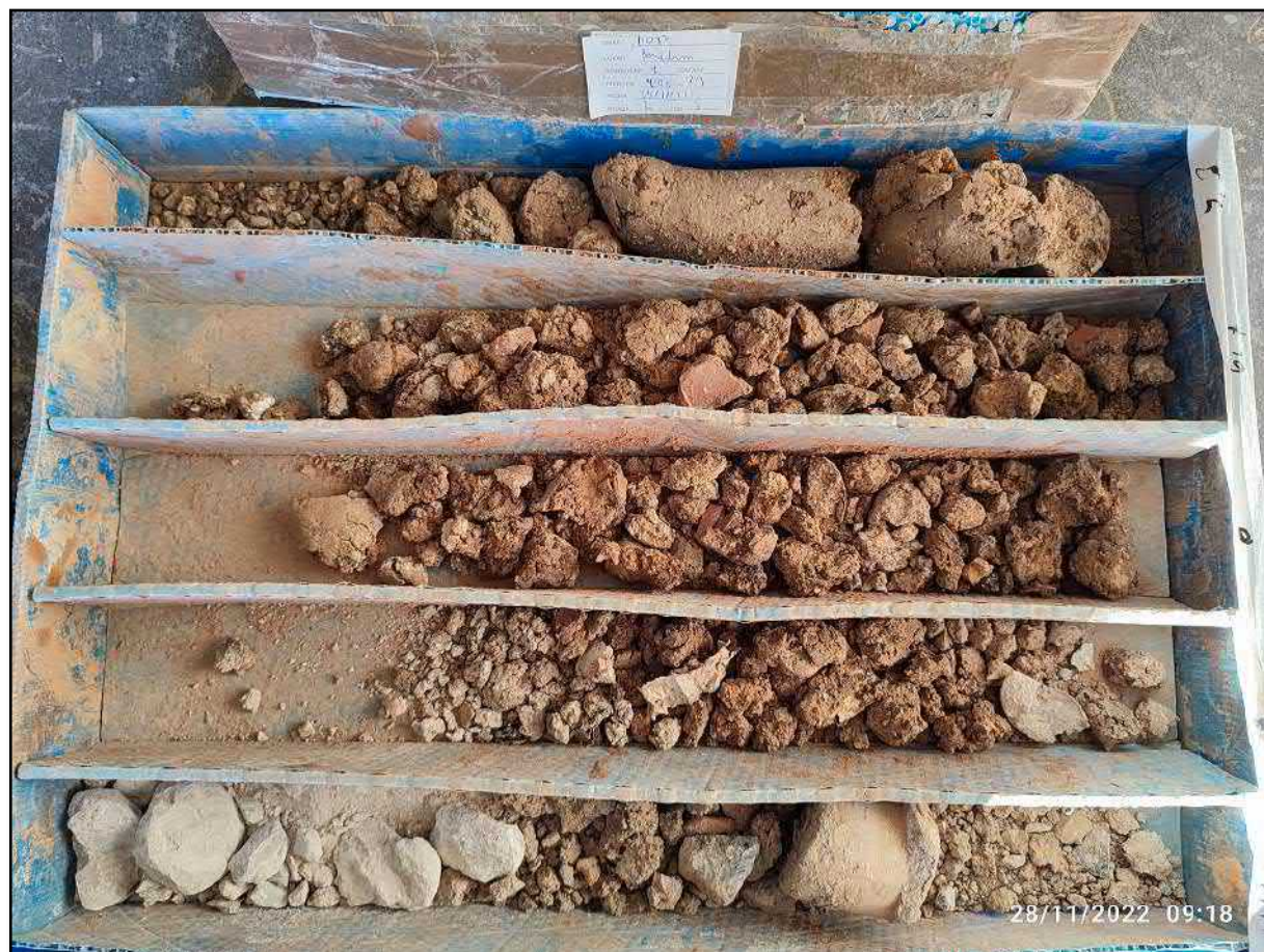
Figura 36: Sondeo n°9. Caja de sondeos 2 (4,00 – 7,30 m)
