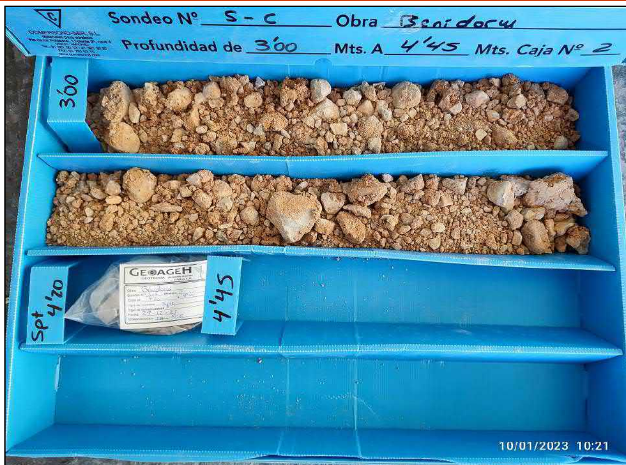
Figura 55: Sondeo C. Caja de sondeos 2 (3,00 – 4,45 m)
