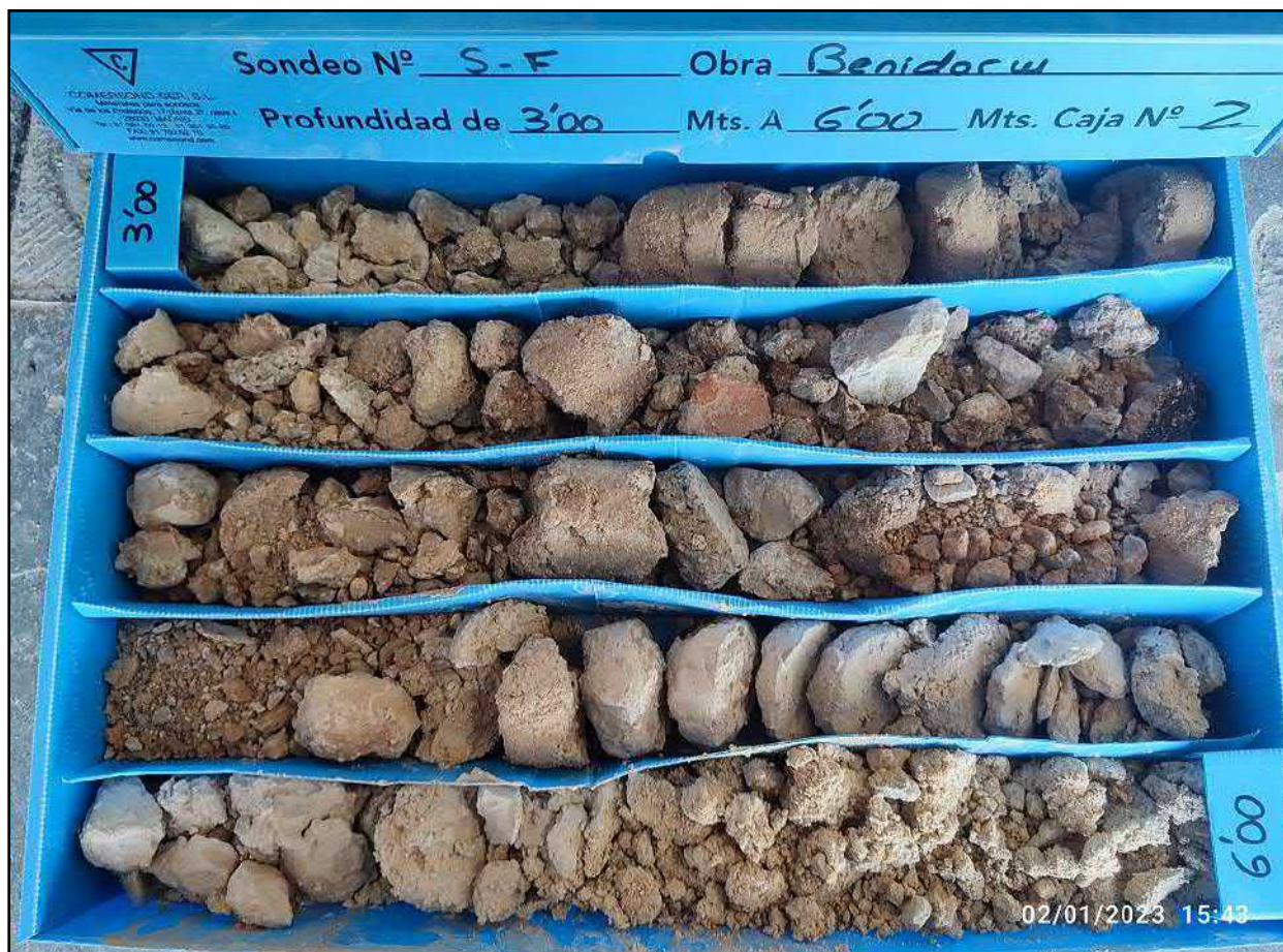
Figura 64: Sondeo E. Caja de sondeos 2 (3,00 – 6,00 m)
