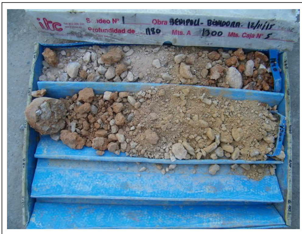
Foto 5. Caja de sondeo. Sondeo 1, de 11,80 a 13,00 m.
