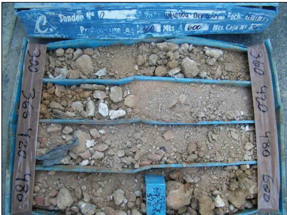
Figura 15: Sondeo a rotación 2*. Caja de sondeos 2 (3,00 – 6,00 m)
