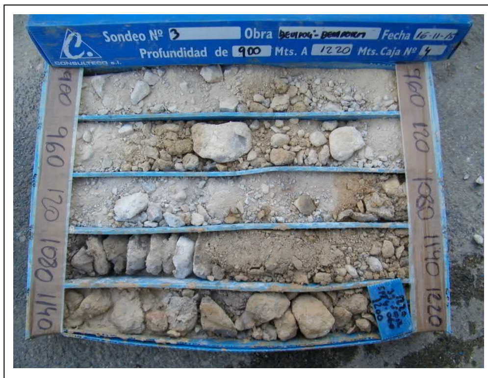
Foto 13. Caja de sondeo. Sondeo 3, de 9,00 a 12,20 m.
