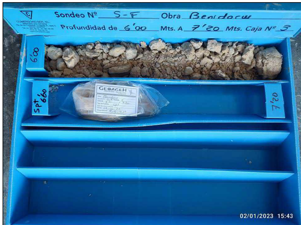
Figura 65: Sondeo E. Caja de sondeos 3 (6,00 – 7,20 m)
