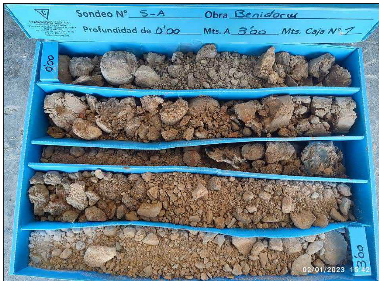
Figura 48: Sondeo A. Caja de sondeos 1 (0,00 – 3,00 m)
