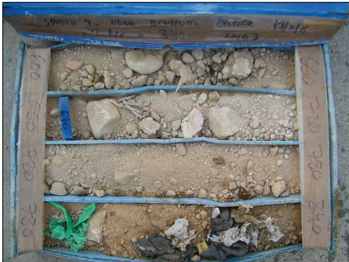
Figura 24: Sondeo a rotación 4*. Caja de sondeos 3 (6,00 – 8,40 m)
