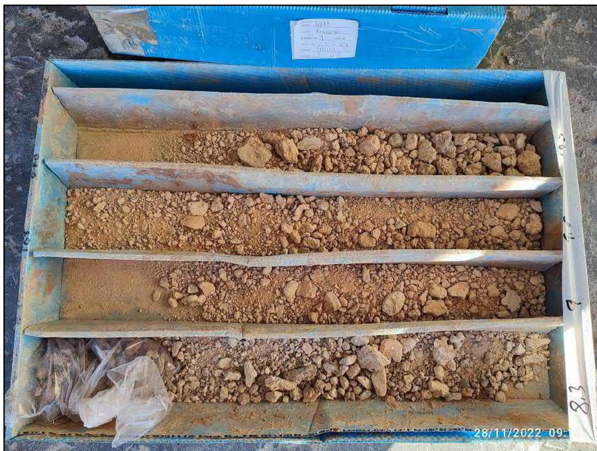
Figura 37: Sondeo nº9. Caja de sondeos 3 (7,30 – 10,30 m)
