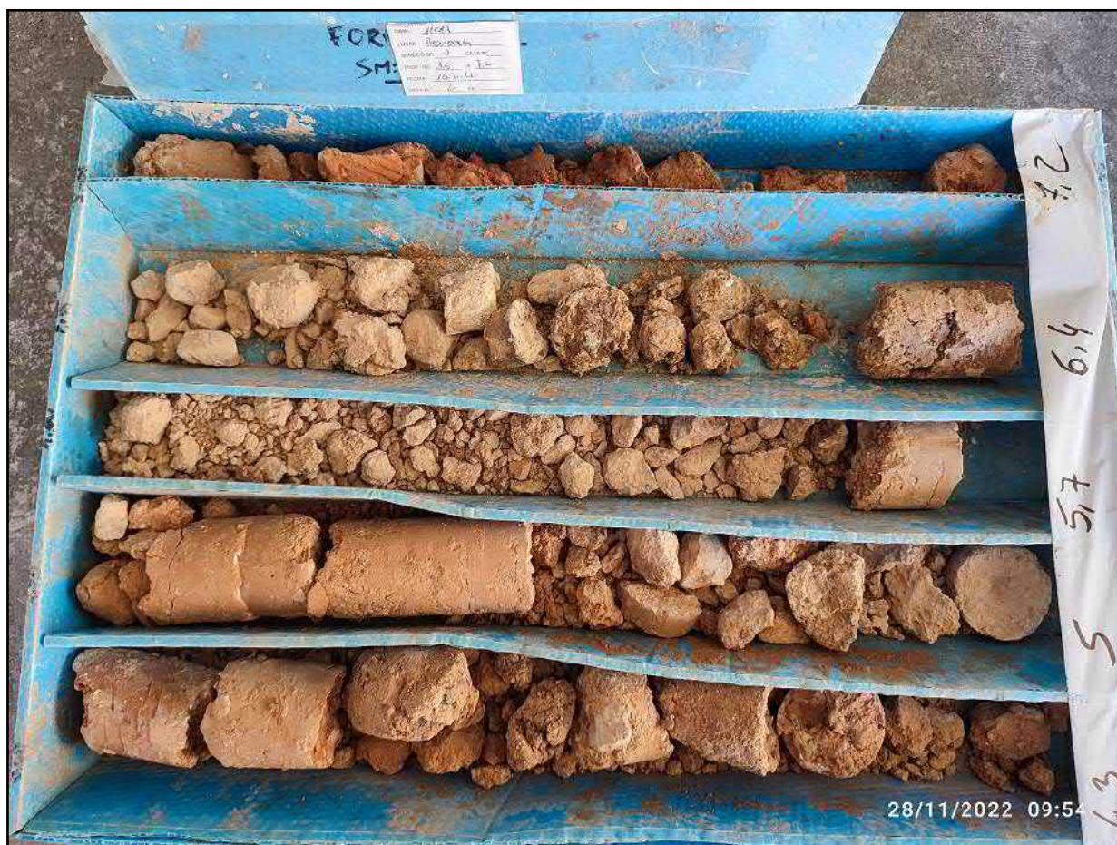
Figura 11: Sondeo n°3. Caja de sondeos 2 (3,60 – 7,20 m)
