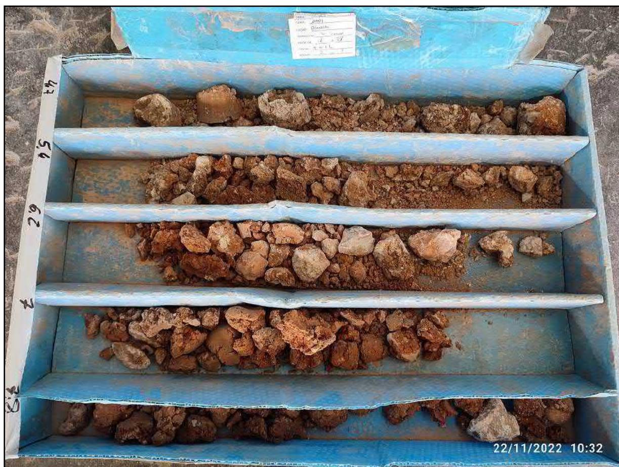
Figura 7: Sondeo n°2. Caja de sondeos 2 (4,00 – 7,80 m)
