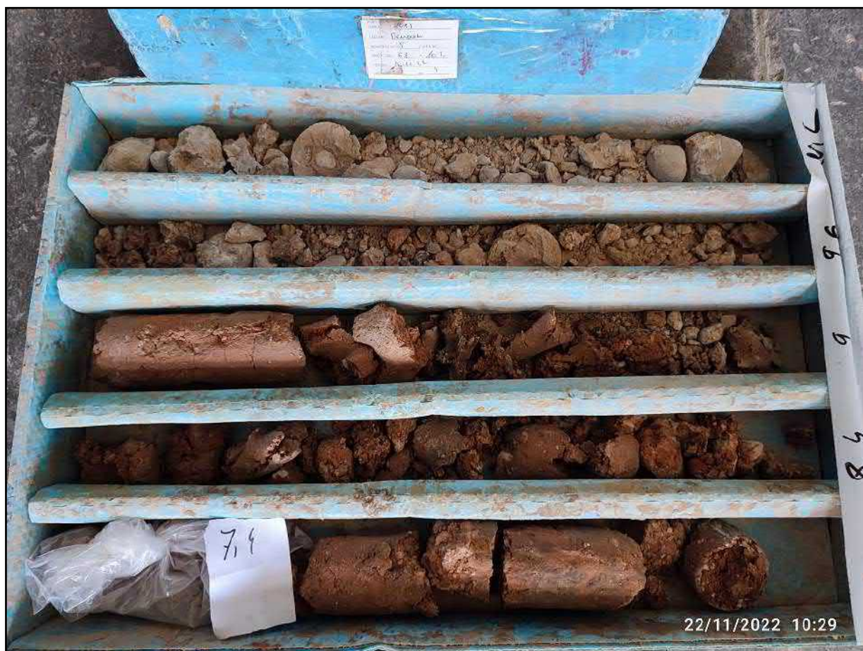
Figura 20: Sondeo n°5. Caja de sondeos 3 (6,80 – 10,20 m)
