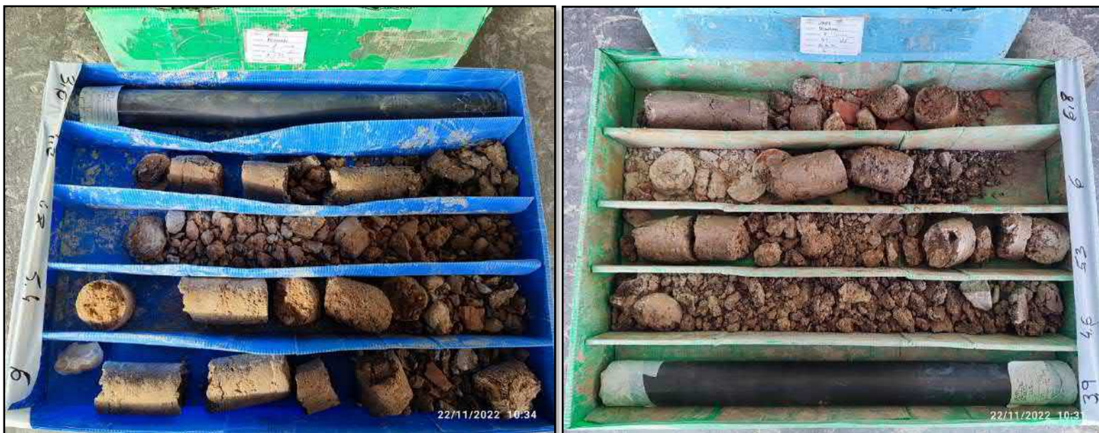
Figura 6: Estratigrafía del nivel I litológico en los sondeos realizados (4,00 – 7,00 m).
