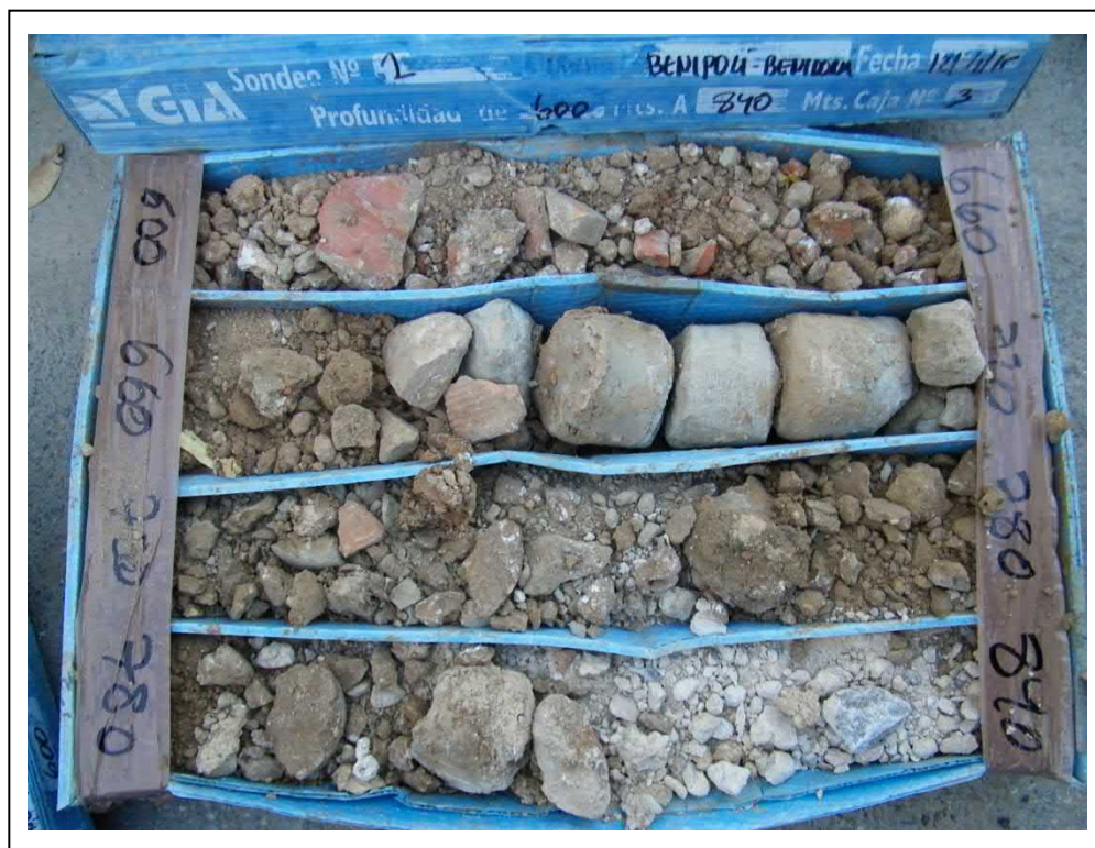
Foto 8. Caja de sondeo. Sondeo 2, de 6,00 a 8,40 m.
