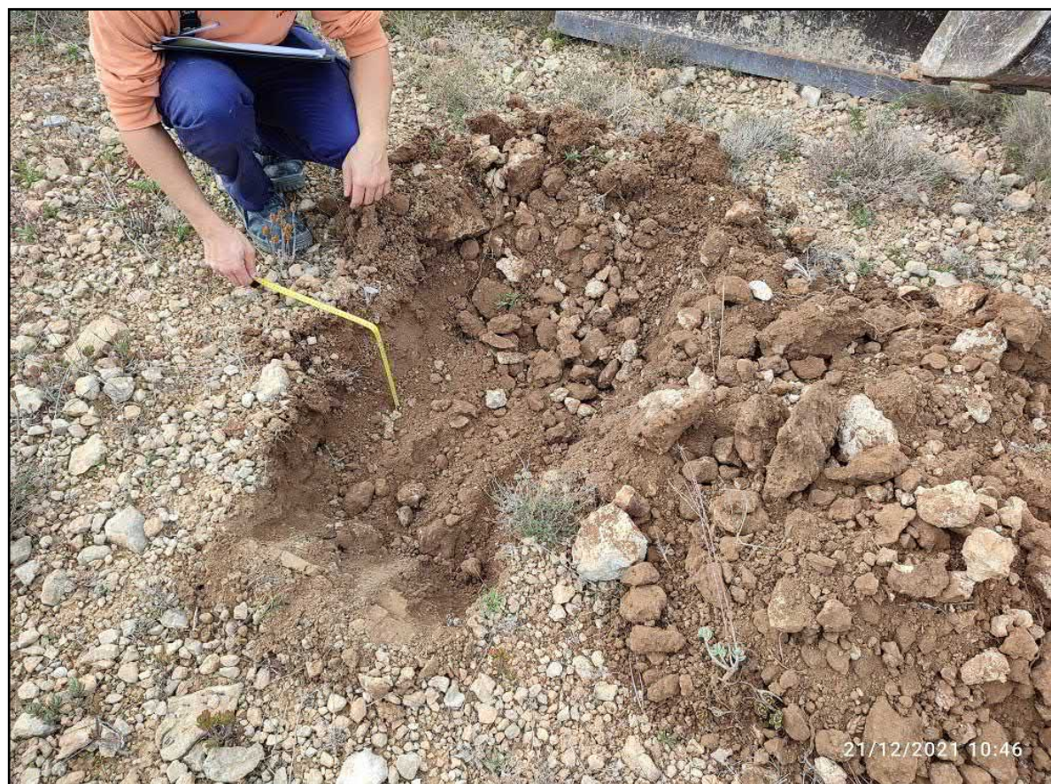
Figura 8: Cata 2 realizada en el terreno. Profundidad 0,20 m.
