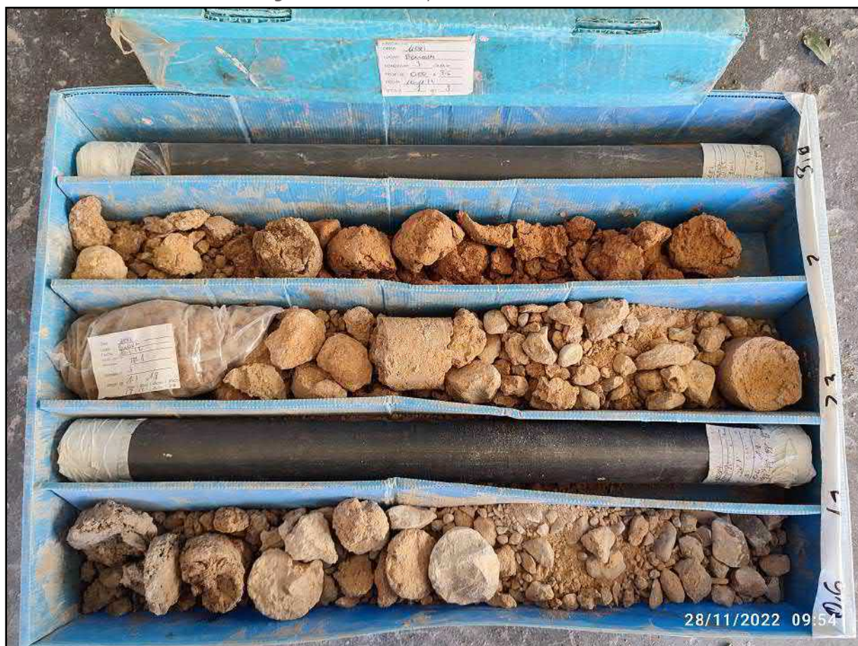
Figura 10: Sondeo nº3. Caja de sondeos 1 (0,00 – 3,60 m)
