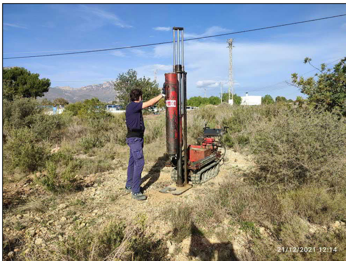
Figura 7: Posicionamiento ensayos de penetración dinámica superpesada (DPSH)
