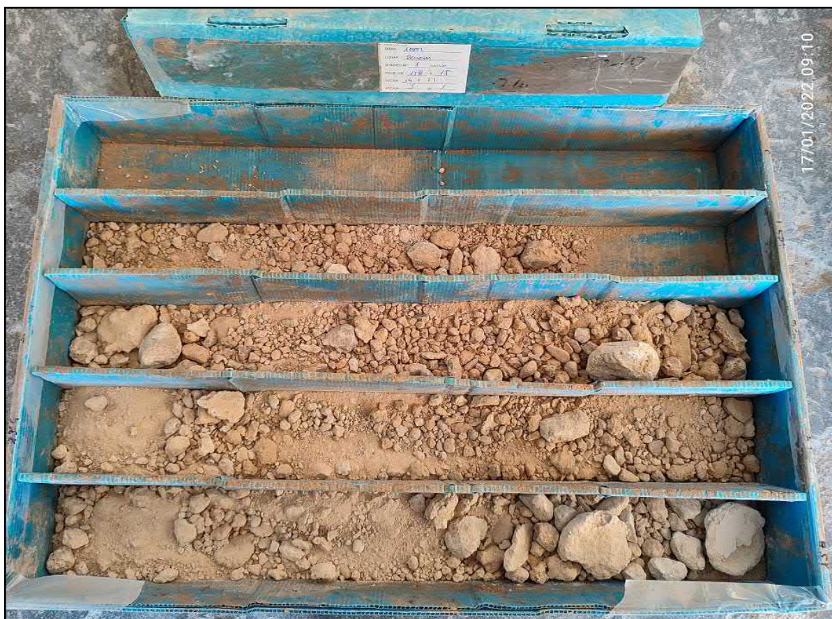
Figura 6: Sondeo a rotación 1. Caja de sondeos 5 (12,80 – 15,00 m)
