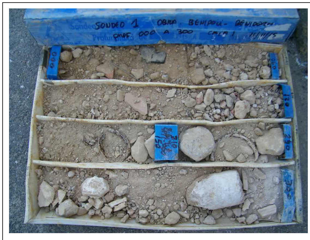
Foto 1. Caja de sondeo. Sondeo 1, de 0,00 a 3,00 m.
