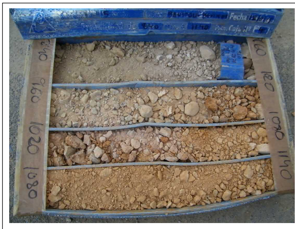
Foto 21. Caja de sondeo. Sondeo 5, de 8,40 a 11,40 m.
