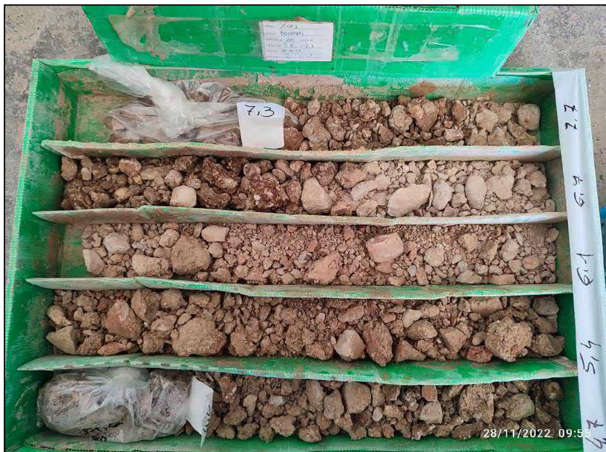
Figura 40: Sondeo n°10. Caja de sondeos 2 (3,60 – 7,70 m)
