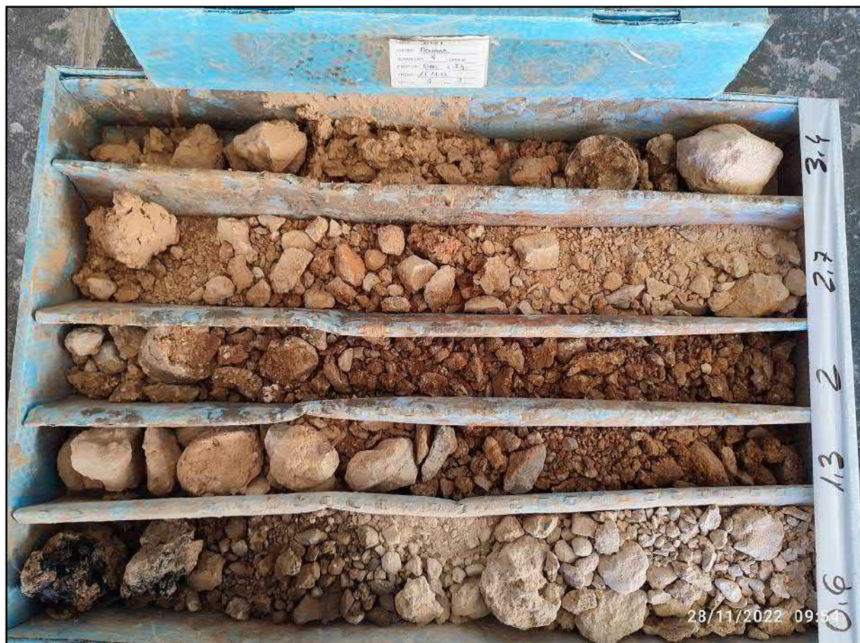
Figura 14: Sondeo nº4. Caja de sondeos 1 (0,00 – 3,40 m)
