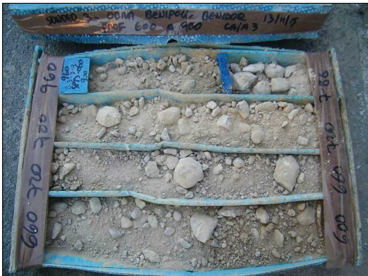
Figura 20: Sondeo a rotación 3*. Caja de sondeos 3 (6,00 – 9,60 m)
