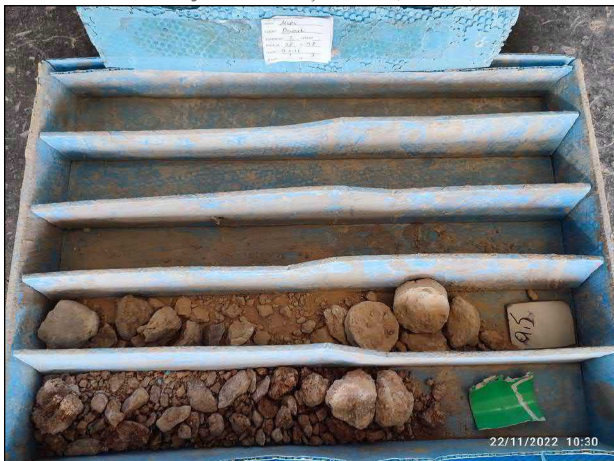
Figura 8: Sondeo n°2. Caja de sondeos 3 (7,80 – 9,70 m)
