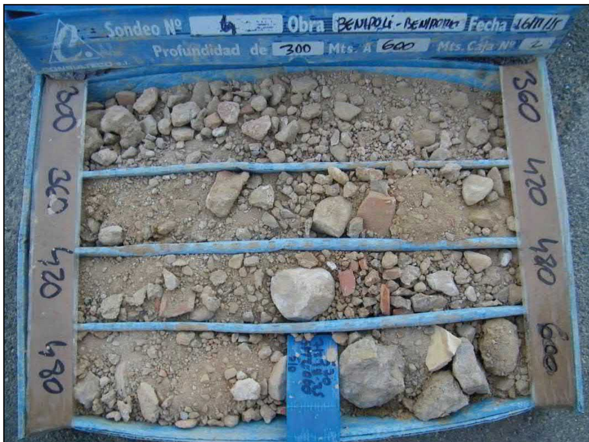
Figura 23: Sondeo a rotación 4*. Caja de sondeos 2 (3,00 – 6,00 m)
